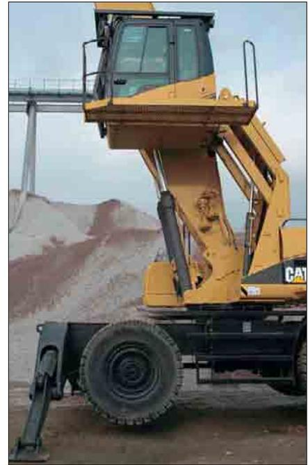
**Obere Position.** Infolge der um 2600 mm angehobenen Kabine genießt der Fahrer eine unversperrte Rundumsicht – ein wichtiges Sicherheits- und Produktivitätskriterium beim Schrott- und Hafenumschlag, das jedoch auch bei allen anderen Verladearbeiten große Vorteile bringt.
