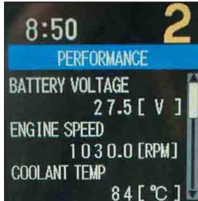
**Monitor.** Auf dem übersichtlichen, grafikfähigen LC-Farbdisplay des neuen Monitors werden dem Fahrer wichtige Maschineninformationen mit hoher Auflösung (400 x 234 Pixel) angezeigt.
