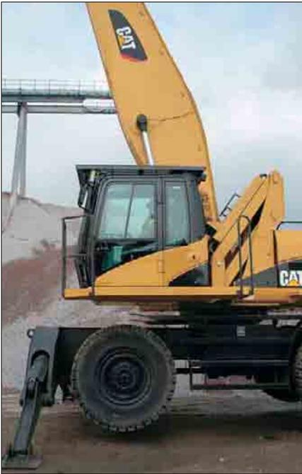
**Untere Position.** Beim Transportieren ist die Kabine in ihrer unteren Stellung zu verriegeln. Diese Position sollte auch gewählt werden, wenn die Maschine über längere Strecken gefahren wird.
