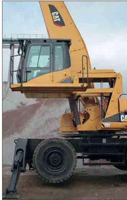
**Mittlere Position.** Wenn die Kabine in die Mittelstellung angehoben wird, verschiebt sie sich automatisch um 500 mm nach vorn, sodass in bestimmten Einsatzsituationen eine zusätzliche Sichtverbesserung eintritt.
