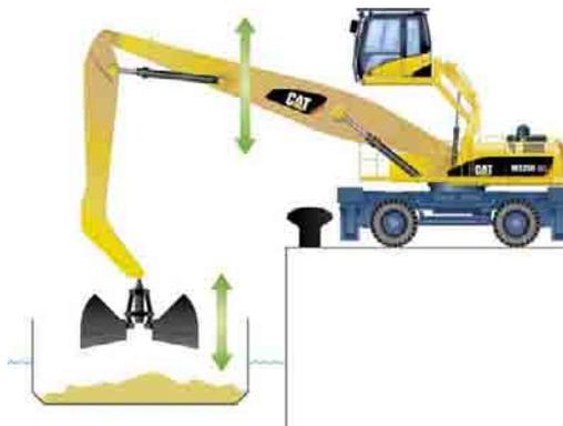
**Schwimmfunktion SmartBoom.** Die serienmäßige Ausleger-Schwimmfunktion erleichtert die Arbeit und verringert die Übertragung von Stößen und Vibrationen auf die Maschine. Beim Löschen von Schiffsladungen endet das Absenken des Greifers automatisch, sobald er auf dem Transportgut aufliegt. Weil er überdies den Schiffsbewegungen frei folgen kann, werden die Rumpfbelastungen auf ein Minimum reduziert.
