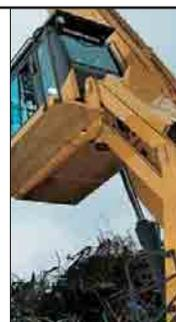
**Seitenplattform.** Der M325D LMH wird serienmäßig mit einer Plattform ausgerüstet, die den Zugang zur Kabine wesentlich leichter macht. Zwei Geländer bieten zusätzliche Sicherheit.
