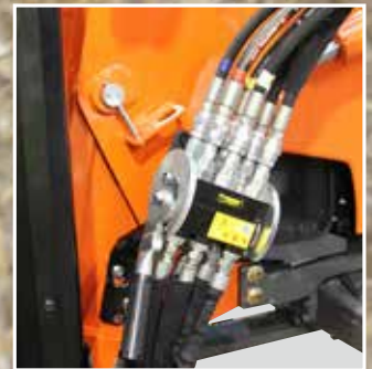
Coupleur hydraulique rapide à levier unique
