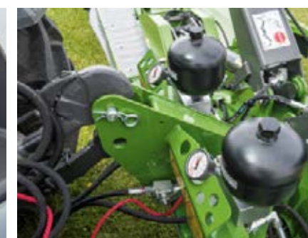
Met behulp van de manometer hebt u steeds zicht op de oplegdruk van het TurboLift-systeem, die u indien nodig vanuit de cabine aan kunt passen.
