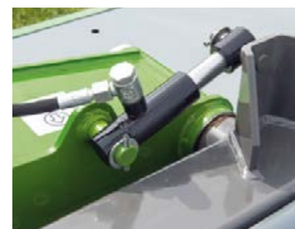
De compensatiecilinder houdt de maaier op de kopakker en bij rijden op de openbare weg veilig op hoogte.
