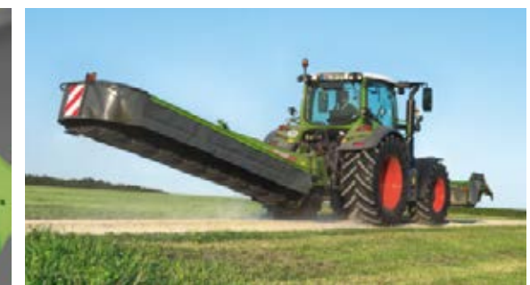
In transportstand wordt de maaier vanuit de cabine 90 graden naar achteren gezwenkt.
