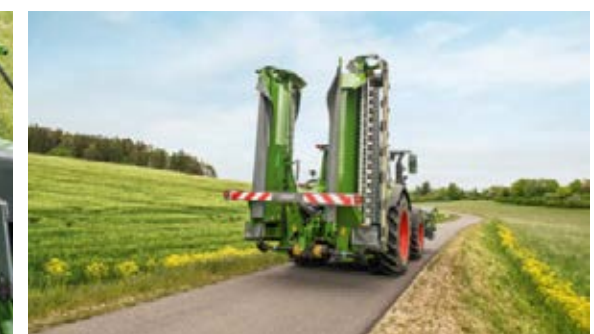
In opgeklapte toestand is de hoogte van de maaiercombinatie nog steeds minder dan 4 meter. Ook zorgt het lage zwaartepunt voor een comfortabel weggedrag.
