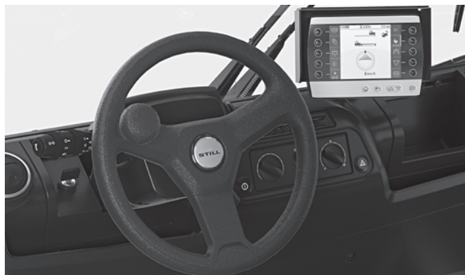
Il volante scorrevole con pomello assicura la massima ergonomia. L'ampio display offre all'operatore una panoramica completa delle informazioni disponibili
