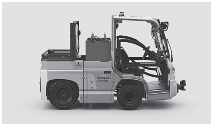
Cambio batteria verticale, in opzione per molti tipi di veicoli
