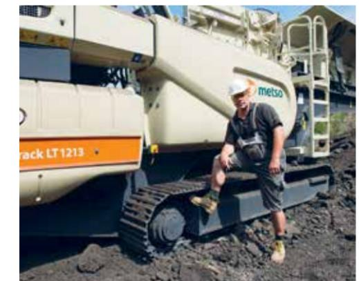
«После начала вторичной переработки асфальта с помощью ударной дробилки Lokotrack LT1213 мы подтвердили расход топлива 24 литра (6,3 гал.) в час, что намного меньше, чем при использовании прежней и меньшей по размеру ударной дробилки».
