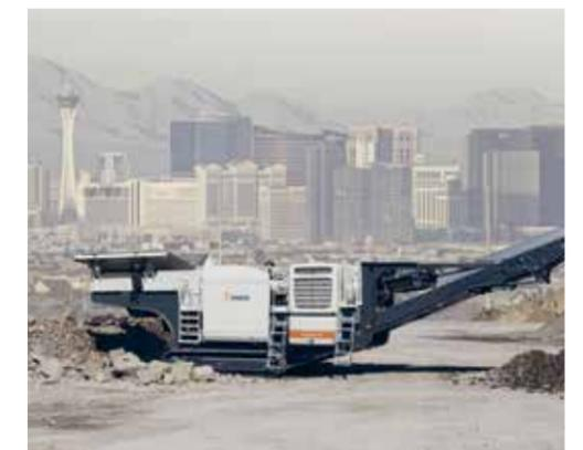
Получение разрешений природоохранных органов на ведение работ по обработке горной породы в густонаселенных районах может быть связано с серьезными сложностями. Для того чтобы облегчить доступ в такие районы, мы разработали дробильную установку Lokotrack® Urban™. Новое решение обеспечивает сокращение расстояния распространения шума интенсивностью до 85 дБ(А) на 60% и значительно снижает выбросы пыли, позволяя выполнять операции дробления там, где это необходимо.
