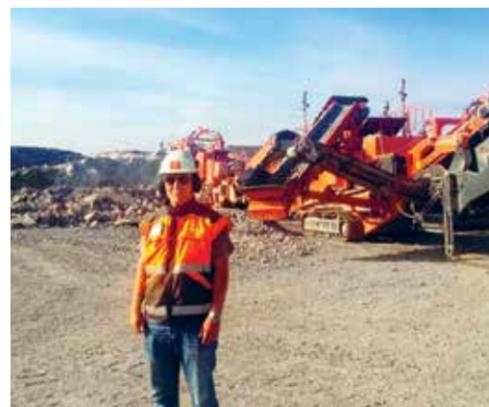
«Наиболее надежный вариант для нас – это сочетание дробилок Lokotrack LT125 и LT550GP. Мы производим более 400 метрических тонн в час (440 коротких тонн в час) продукта крупностью 0–90 мм (0–3½") и хотим отметить высокие эксплуатационные возможности этого оборудования».
