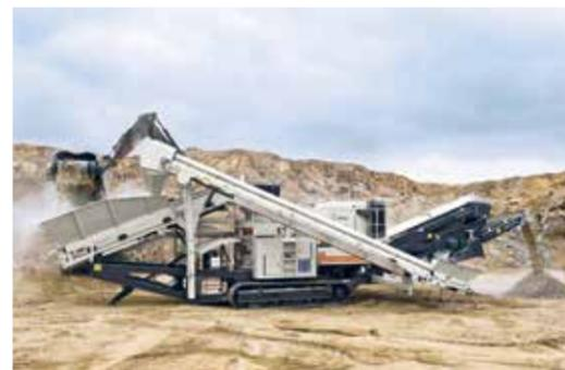
Конусная дробилка Lokotrack® LT200HPS™ может быть оборудована однодечным или двухдечным съемным грохотом.
