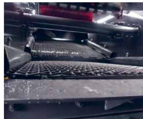
Грохот с двумя углами наклона обеспечивает эффективную классификацию продукта
