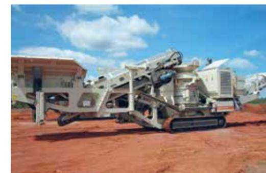
Установка Lokotrack LT300HP поставляется с ленточным питателем или вибрационным колосниковым питателем.
