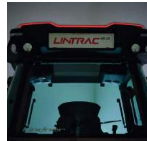
Auf Wunsch sind leuchtstarke H7-Halogen oder LED-Arbeitscheinwerfer erhältlich. Für den Kommunaleinsatz kommen extrem gut sichtbare LED-Rundumleuchten und Blitzbalken zum Einsatz. Um auf besondere Einsätze aufmerksam zu machen kommen LED-Blitzleuchten zum Einsatz die sich perfekt in die TracLink-Dachschale einfügen – ohne Nachteile für die Bauhöhe.
