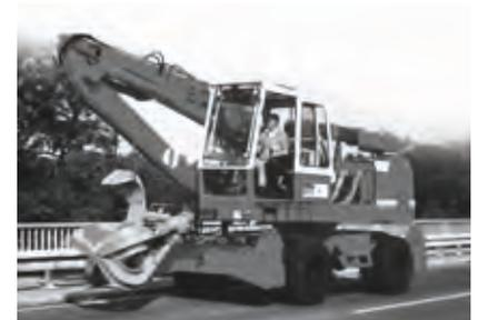
Erste hydraulisch verstellbare Kabinenerhöhung
