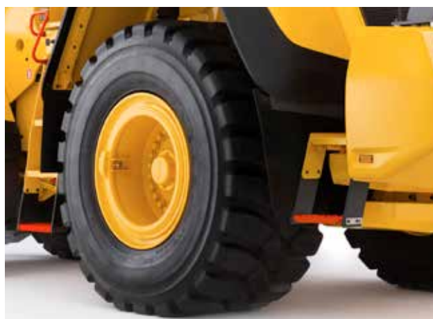
Pneumatici posteriori gonfiati a liquido idraulico
