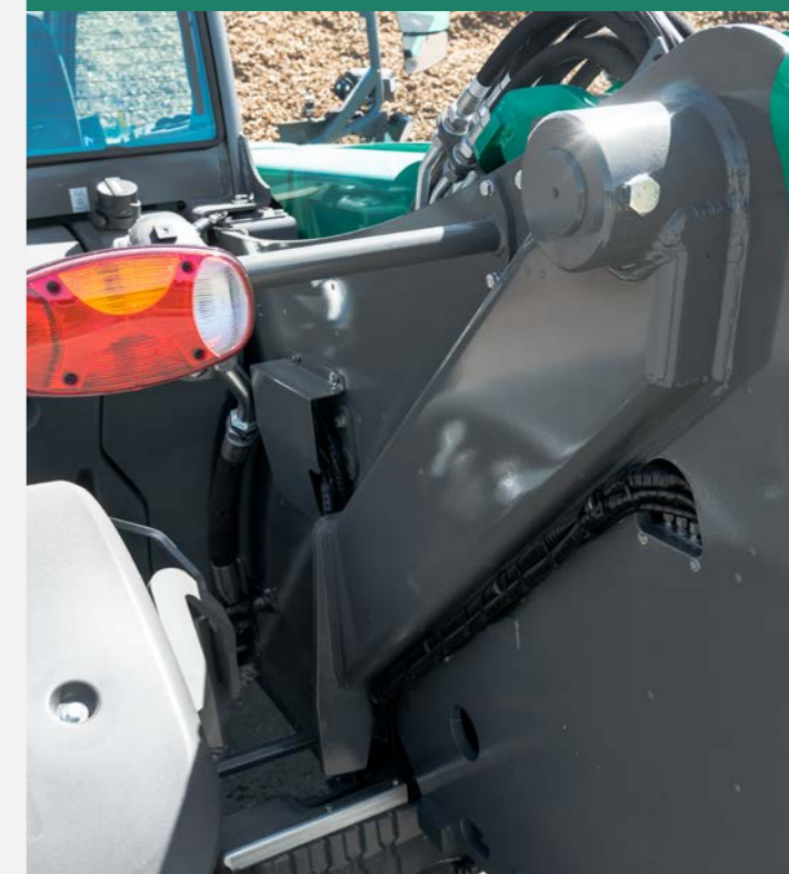
Rinforzo del telaio sul braccio principale
