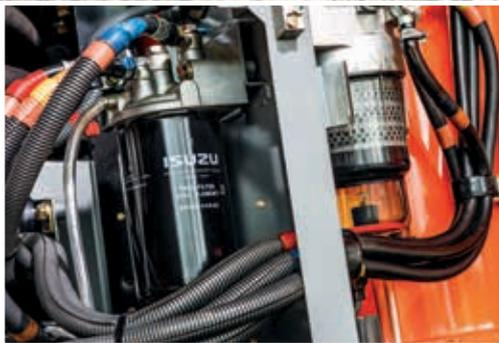
Der Kraftstoffhauptfilter lässt sich einfacher auswechseln.
