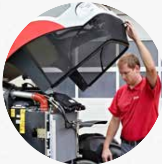
Il cofano motore monopezzo, ammortizzato, può essere sollevato anche con l'attrezzo anteriore montato.
