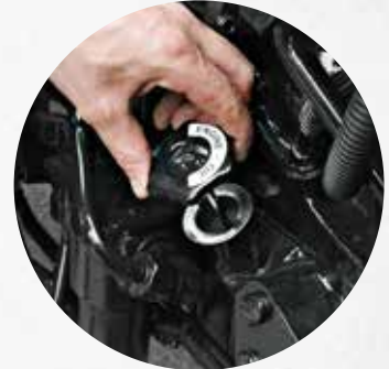
Controllo del livello dell'olio e rabbocco senza sollevare il cofano del motore.
