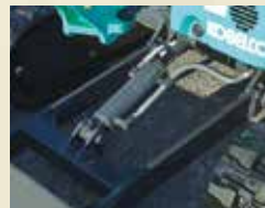
Zusammengeführte Planierschläuche zum einfachen Wechseln
