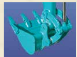
Gelenkbolzen mit Splint / Löffelschwinge aus Stahlguss
