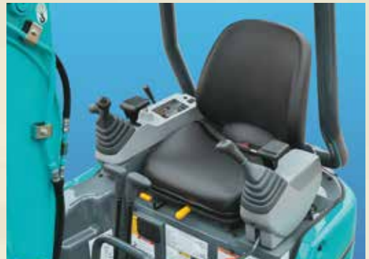
Drei-Säulen-Schutzdach gemäß ROPS und FOPS, Stufe 2
