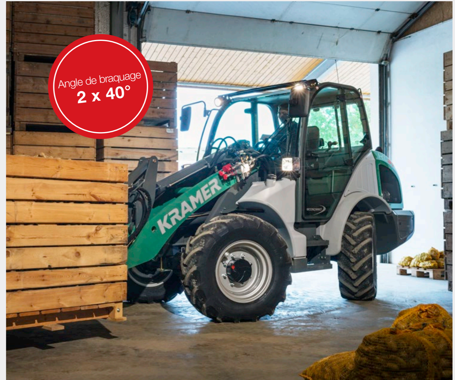
Quatre roues directrices pour une grande maniabilité, en particulier dans les espaces restreints
