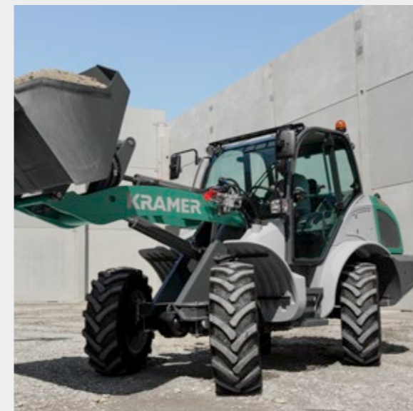
Direction marche en crabe pour manœuvrer dans des espaces confinés
