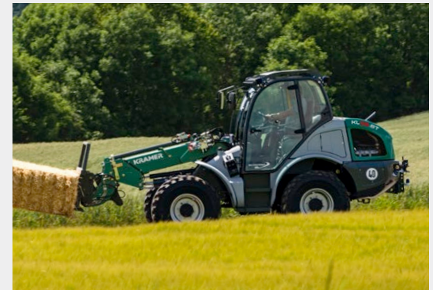
Essieu avant directionnel pour une sécurité accrue lors des opérations de transport rapides
