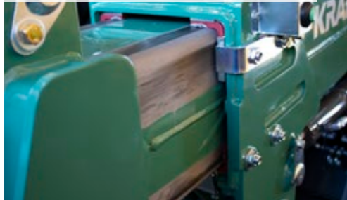
Amortiguación de final de carrera (KL25.5T)
