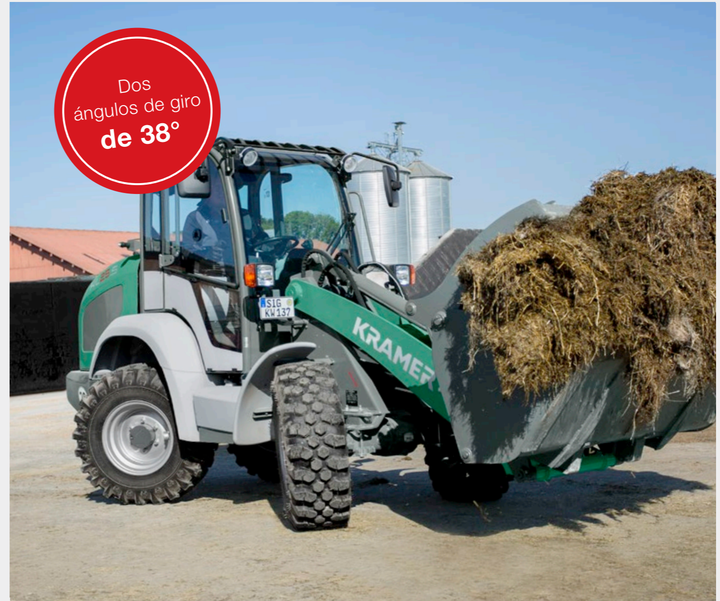
Dirección a las cuatro ruedas muy maniobrable en espacios estrechos.
