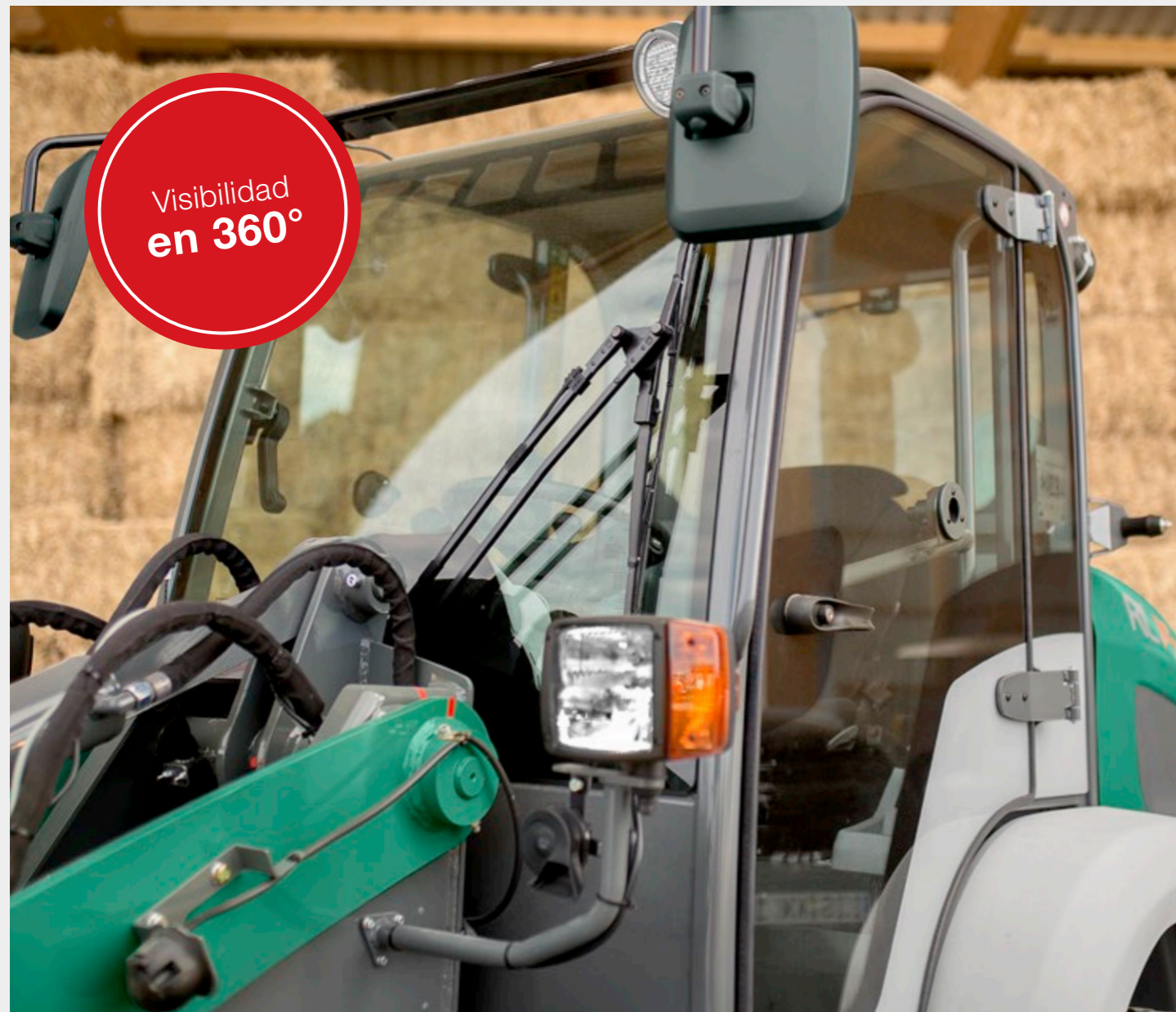
Cabina panorámica para una excelente visión general del accesorio y el entorno de trabajo.
