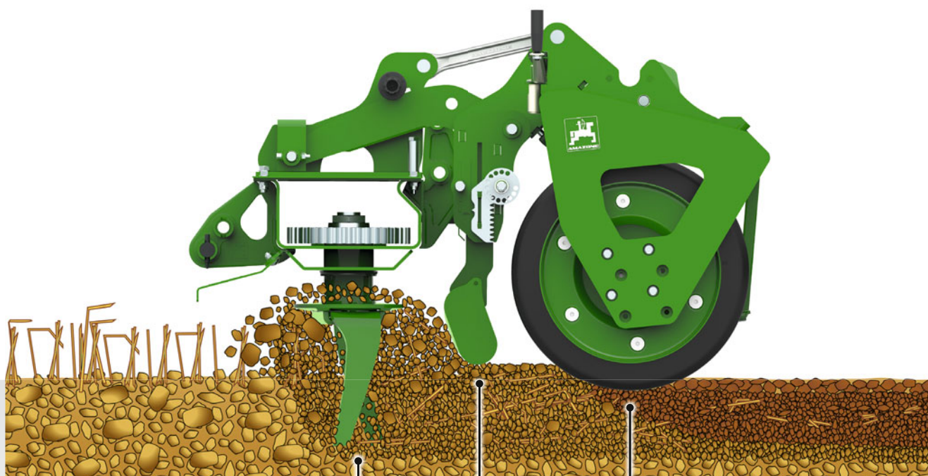
Rotační kypřič KG se šikmými hřeby „naostro“
