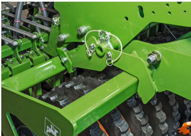
✓ Rychloupínací systém QuickLink – snadné a rychlé připojování a odpojování bez použití nářadí
