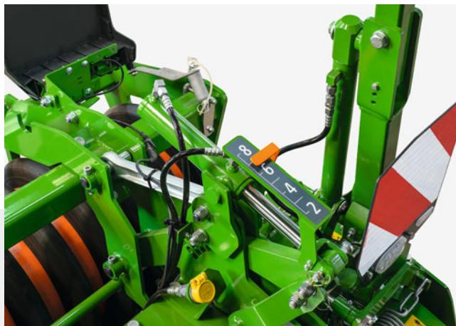
Гидравлическая регулировка глубины
