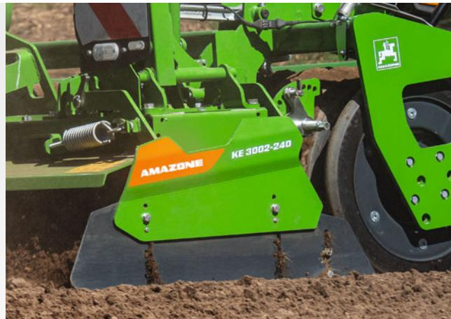
! «Ведение по глубине планировочной балки осуществляется за счет катка. При большей глубине обработки ротационного культиватора нет необходимости в юстировке».
