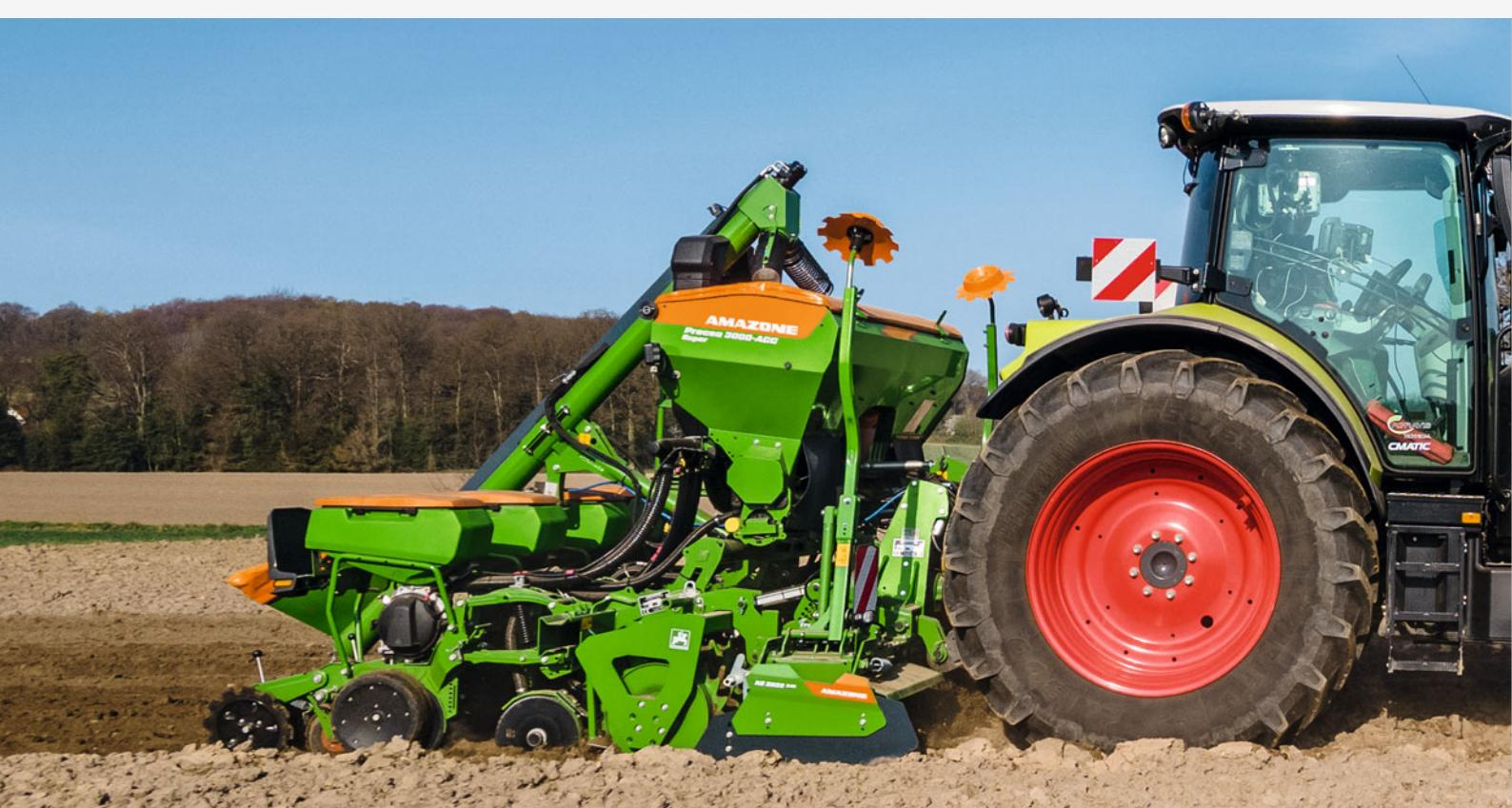
Ротационная борона KE 3002-240 с сеялкой точного высева Precea 3000-ACC Super
