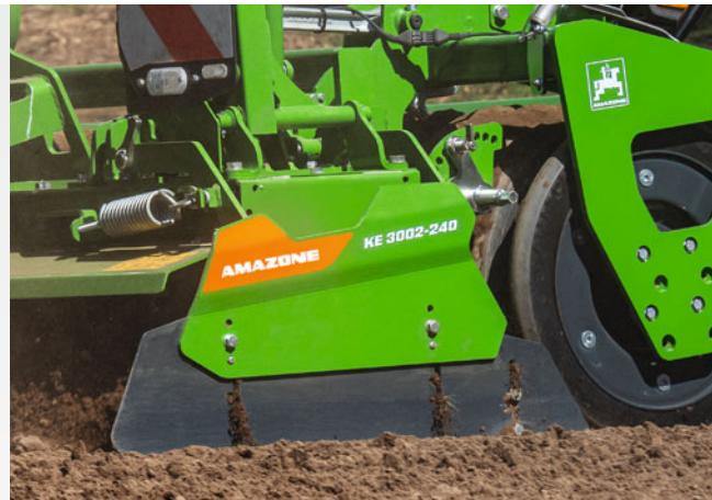
! « La lame de nivellation est guidée en profondeur par le rouleau. Il n'est plus nécessaire de réajuster le réglage lorsque le cultivateur doit travailler plus en profondeur. »
