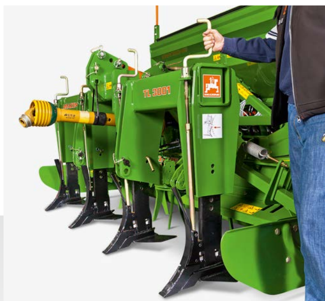
Ajuste sencillo de la profundidad de labrado
