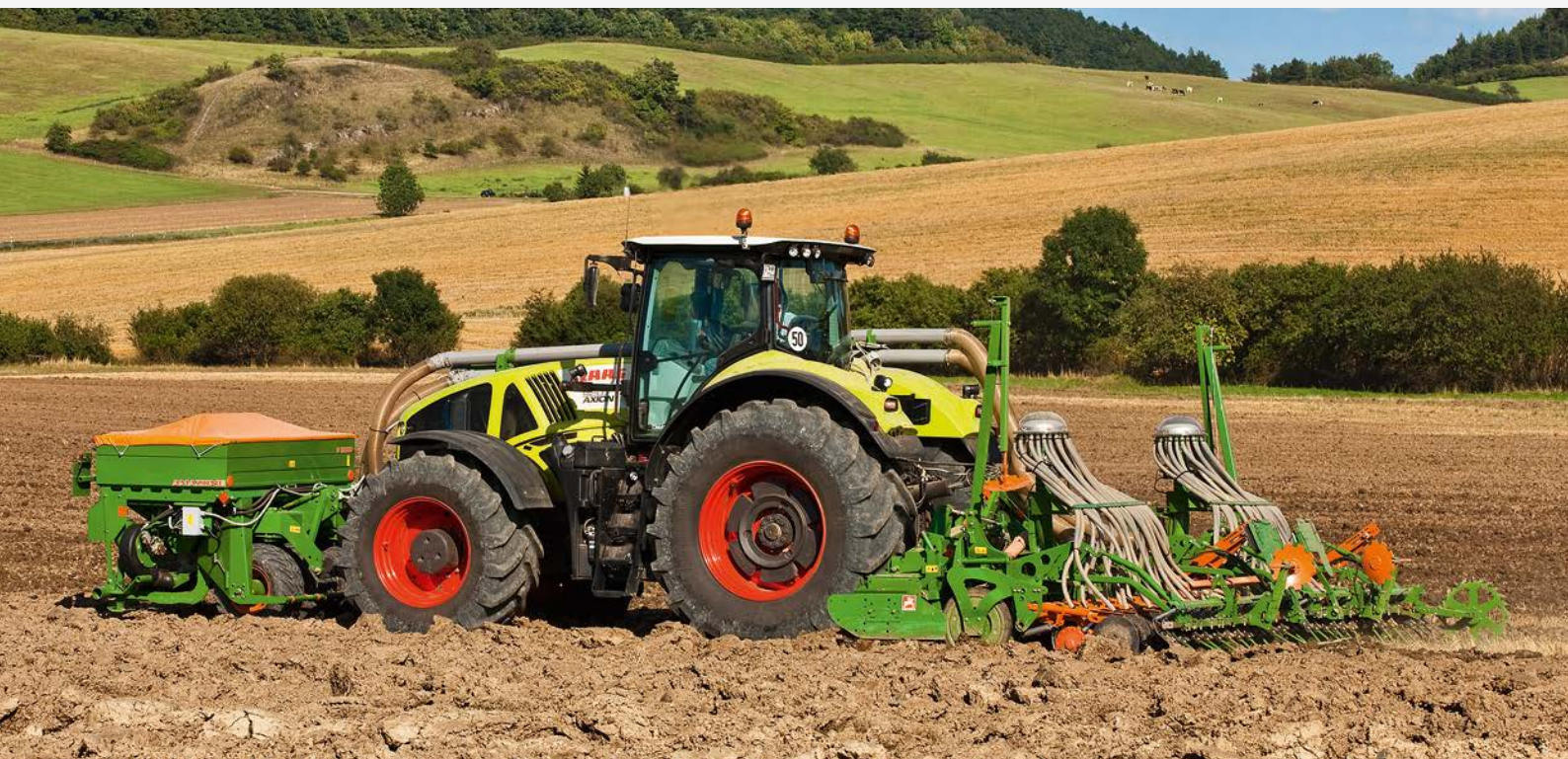
Sembradora combinada con tolva frontal Avant, 6 m de anchura de trabajo
