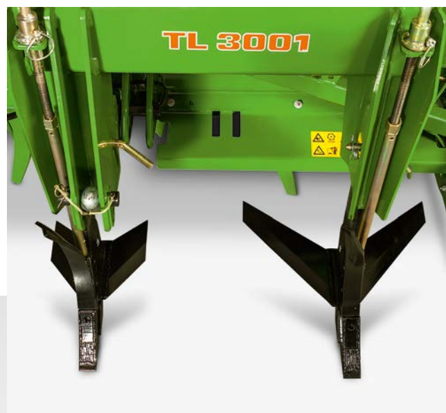
Rejas de aletas con 30 cm u, opcionalmente, con 60 cm de anchura
