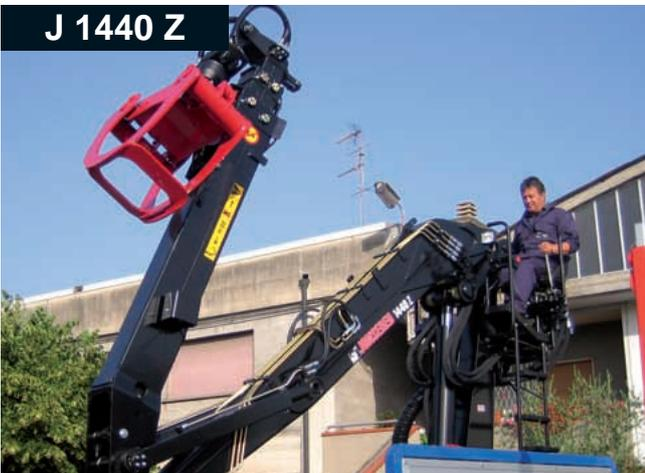
Der **JONSERED 1440 Z** lässt sich quer zur Fahrtrichtung zusammenlegen und ist leistungsstärker als andere Krane dieser Größenordnung. Er kann auch schwerste Lasten problemlos verladen. Das innovative Z-Design und das leistungsstarke Doppelschwenksystem sorgen für seine hohe Leistung. Das Kraftgelenk erhöht die Hubkapazität im Nahbereich.
