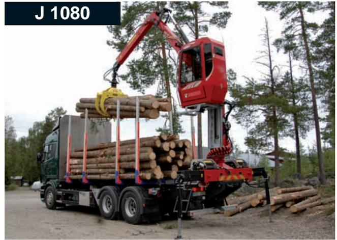
Der **JONSERED 1080** mit einem kraftvollen Doppel-Schwenkwerk wurde für die Kunden entwickelt, die viel Holz verladen. Bei der Krankonstruktion wurde viel Wert auf einfache Wartung gelegt. Mit dem neuen ergonomischen Steuerplatz ist die Arbeit mit dem Kran komfortabler denn je. Der Kran kann mit manueller Steuerung oder digitalem elektrischem Steuersystem ausgerüstet werden.
