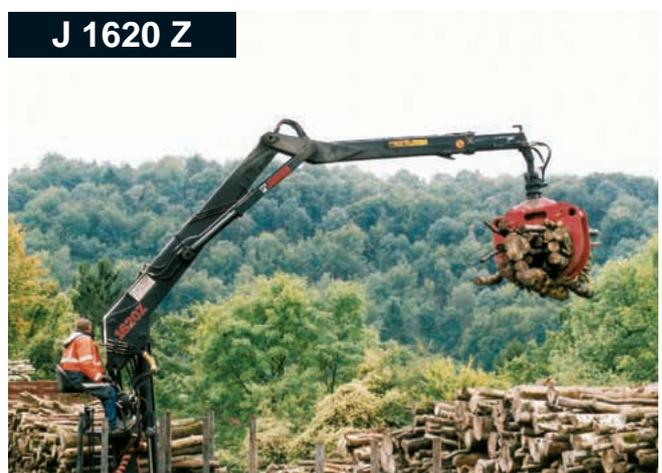
Der **JONSERED 1620 Z** hat sich als äußerst robuster Kran bewährt, der speziell für die Arbeit unter Dauerbelastung entworfen wurde. Der Kran ist in erster Linie für das Verladen von Kurzholz konzipiert, verfügt aber über ein ausreichendes Hubmoment zum Verladen von stärkerem oder längerem Holz. Der schmale Ausleger ermöglicht eine ungehinderte Sicht vom ergonomischen Fahrerplatz aus auf den gesamten Arbeitsbereich.
