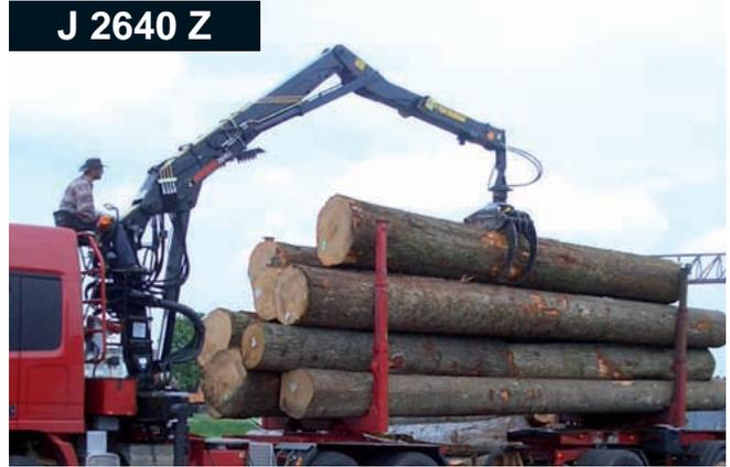
**Das Platzgenie: J 2640 Z** Der JONSERED 2640 Z legt sich quer zur Fahrtrichtung zusammen. Diese platzsparende "Ruheposition" ist die ideale Lösung gerade für LKWs mit hohen Fahrerständen. Trotz seiner kompakten Bauweise verfügt der J 2640 Z über eine der größten Reichweiten seiner Klasse. Die besondere Konstruktion der Kransäule ermöglicht ein Hubmoment, das dem von Kranen mit gestrecktem Armsystem in nichts nachsteht.
