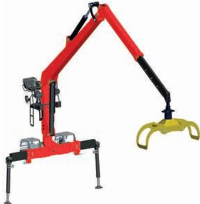
Die Konstruktion des **Jonsered 900** Krans basiert auf erprobten und in der Praxis unter den Extremverhältnissen bewährten Lösungen um harten Arbeit gerecht zu werden. Spitzenklasse ist das günstige Leistungs-Gewichtverhältnis des J 900 Krans. Wahlweise stehen zwei Kransäulenhöhen- und mehrere Reichweiten-Varianten zur Verfügung. Erhältlich sind optional Lasthalteventile und extra breite Abstützungen. Das Schwenkwerk des Krans ist kräftig und zuverlässig.
