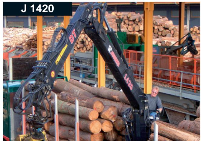
Der **JONSERED 1420** ist das Schwergewicht unter den JONSERED-Holzladekränen und bietet eine zuverlässige, effektive und einfache Verladung. Durch die separate Abstützung bietet der J 1420 individuelle Einbaumöglichkeiten.
