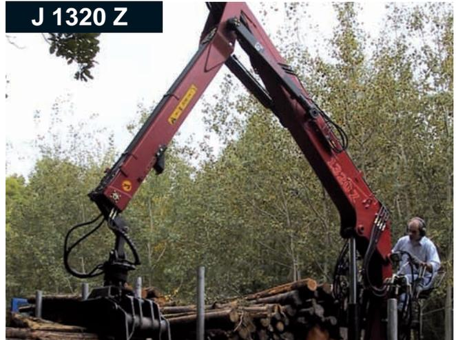
Der **JONSERED 1320 Z** ist ein äußerst leistungsstarker leichter Kran für die kontinuierliche Holzverladung. Dieser Kran kann für den Transport zusammengelegt werden. Die geneigte Säule garantiert optimale Hublasten bis in den Nahbereich. Die Hydraulikschläuche verlaufen im Inneren des Auslegers, wodurch sich die Zuverlässigkeit dieses robusten Krans zusätzlich erhöht.
