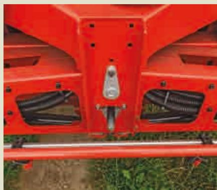
Bloccaggio idraulico dell'inclinazione
