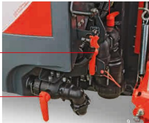
Il pannello di controllo rende intuitive tutte le operazioni. Le funzioni di aspirazione e di irrorazione sono separate sul pannello di controllo. Il quale è posizionato sulla parte sinistra della botte.
