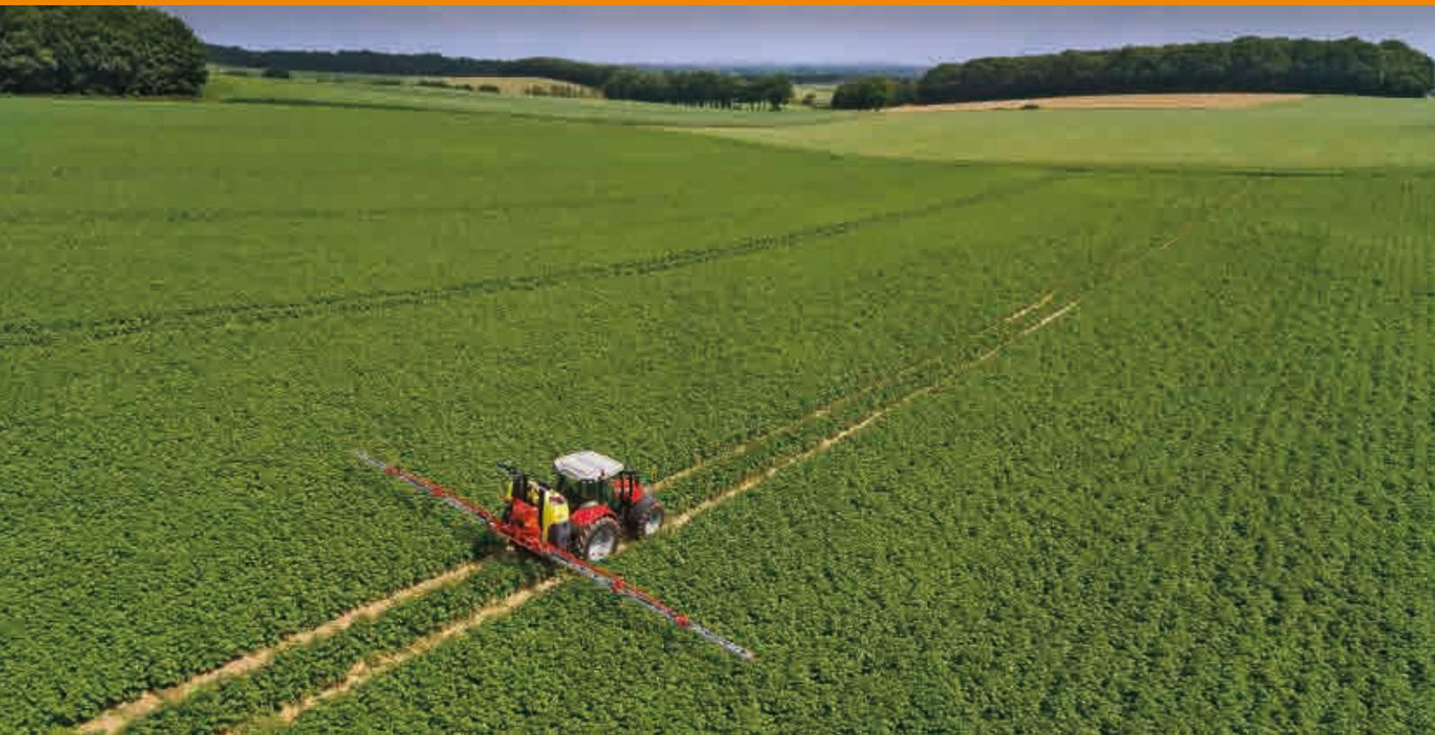
Il sistema esclusivo di ripiegamento a Z della barra HOSA assicura all'operatore una grandissima manovrabilità anche in presenza di diversi ostacoli. La costruzione totalmente in alluminio è stata progettata per resistere a lungo. L'assenza di saldature conferma la sua grande resistenza ed il suo trattamento anodizzato la protegge dalla corrosione o dalle rigature.
