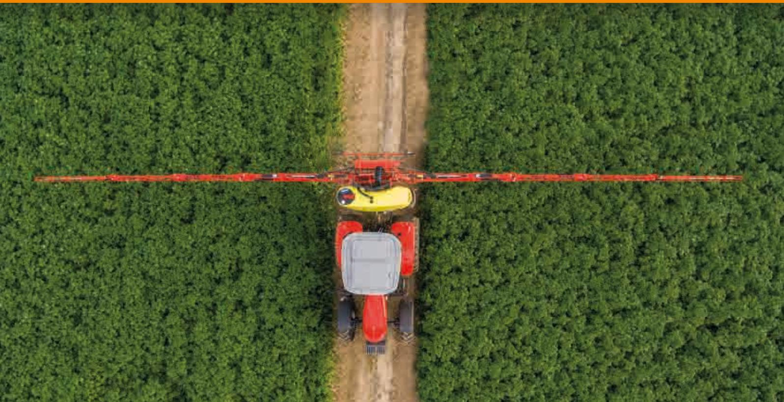
Questa nuova generazione di barre a geometria variabile completamente in acciaio assicura all'operatore alte velocità di lavoro anche in condizioni molto gravose. Il sistema di bilanciamento assicura una perfetta sospensione della barra in tutte le situazioni.
