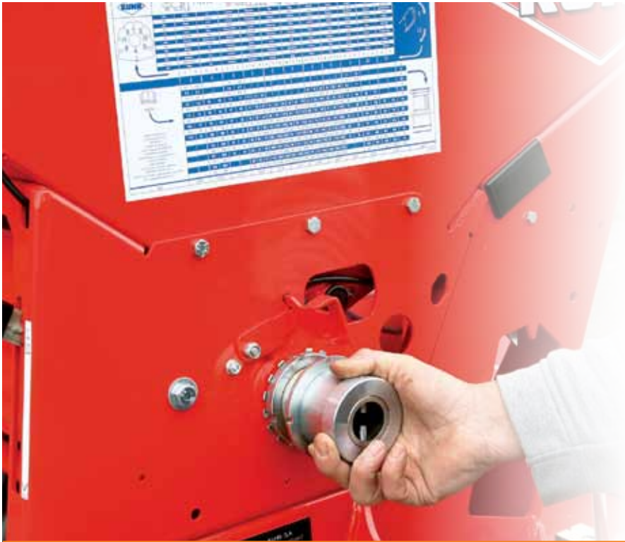
Feindosierrad für eine extrem präzise Einstellung
