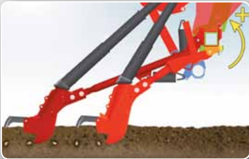
Position des unteren Verstellanschlags bei einer Sätiefe von 8 cm
