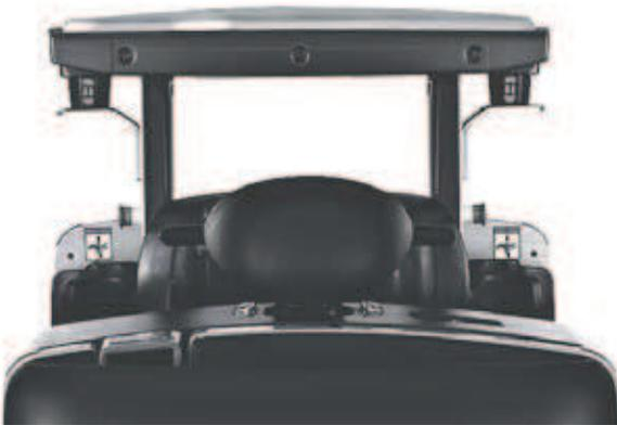
Individuelles Kommissionieren: Das Fahrzeug passt sich den Bedienervorlieben an. Ein optisches Signal zeigt die links-, rechtsseitige oder mittige Ausrichtung am Regal an.
