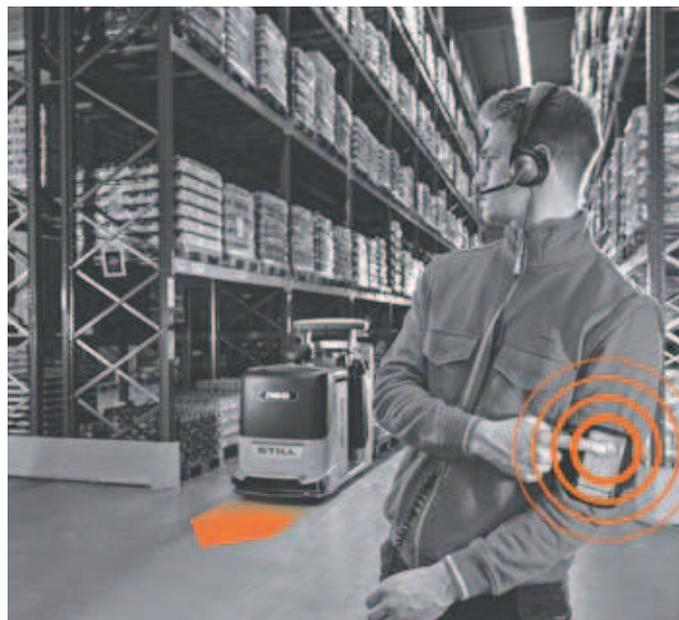
Prozesssicherheit auch bei leeren Regalfächern oder Kreuzungen: Der iGo neo CX 20 erkennt leere Regalfächer und passiert diese. Auch Querwege werden frühzeitig erfasst und erst nach Bedienerfreigabe – wenn der Fahrweg frei ist – autonom überquert.
