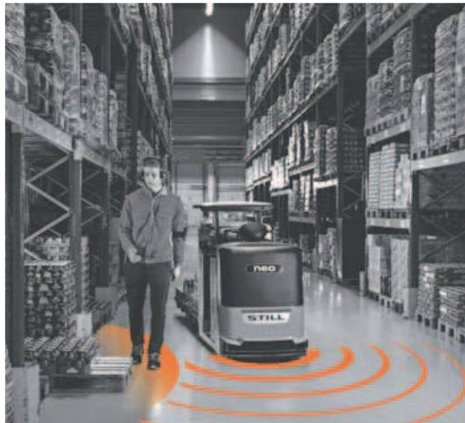
Präzise bei Hindernissen: Der iGo neo CX 20 weicht autonom Hindernissen aus und handelt situationsabhängig. Hindernisse werden entweder umfahren, mit einer Kolonnenfahrt umgangen oder das Fahrzeug stoppt, wenn diese den Weg komplett blockieren.
