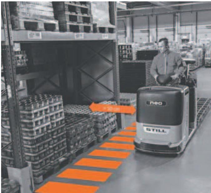
Berücksichtigung individueller Kommissioniervorlieben: iGo neo CX 20 einfach an gewünschter Stelle abstellen. Das Fahrzeug hält autonom genau den Abstand zum Regal, den der Bediener vorgibt. Wird der Sicherheitsabstand von 500 mm unterschritten, passt das Fahrzeug diesen beim Wiederauffahren an. Die relative Fahrzeugposition zum Bediener und Regalausrichtung kann aus der Ferne nachjustiert werden. Dies verkürzt wiederum die Laufwege.
