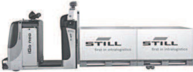
Hochleistungskommissionieren: Je nach Wunsch des Bedieners fährt das Gerät bis zur ersten oder zweiten Palettenposition vor. Selbst Zwischenpositionen sind möglich.
