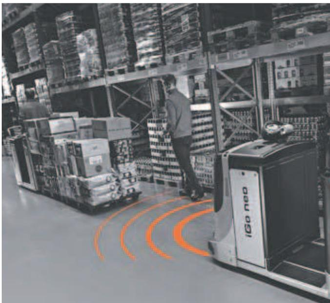
Geschwindigkeit der Umgebung angepasst: Fährt ein langsam fahrendes Fahrzeug voraus oder entsteht ein Stau, passt der iGo neo CX 20 seine Geschwindigkeit der Situation intelligent an. Läuft die kommissionierende Person währenddessen schon voraus, schließt das Fahrzeug autonom wieder auf, nachdem sich der Stau aufgelöst hat.
