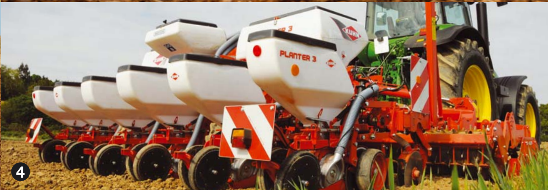
1. Combinata con seminatrice meccanica integrata: COMBILINER INTEGRA, COMBILINER SITERA . 2. Seminatrice pneumatica combinata in linea: COMBILINER VENTA . 3. Combinata con tramoggia frontale e barra di semina posteriore: TF 1500 + BTF/BTFR . 4. Combinata con seminatrice monogerme telescopica: MAXIMA 2 o PLANTER 3 .
