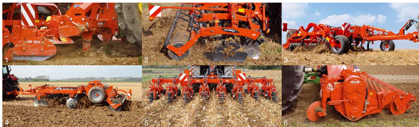
1. Decompattatori - 2. Coltivatori a dischi - 3. Coltivatori a denti - 4. Coltivatori a dischi tipo cover crop - 5. Strip till - 6. Erpici rotanti.
