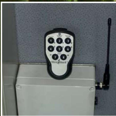
Optional liefern wir die Funkfernsteuerung T60 für kranbeschickte Hacker. Die Fernsteuerung bietet die gleichen Funktion wie die kabelgebundene HE 002.
