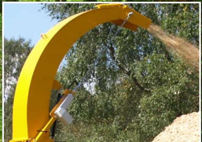
Der HM 6-300 VM zieht Stammholz mit einem Durchmesser bis 30 cm über einen hydraulisch angetriebenen Zwangseinzug mit Einzugs-kette und Einzugsrolle zuverlässig ein. Die hervorragende Arbeitsleistung sowie das Tandem-Fahrwerk, mit welchem bis zu 80 km/h gefahren werden kann, sprechen für diese Hackerbaureihe.
