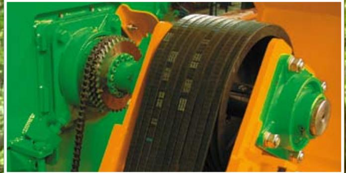
Über ein 10-rilliges Keilriemen-Vorgelege wird eine Übersetzung erzeugt, die es ermöglicht, verschiedene Wellendrehzahlen kraftvoll zu übertragen.
