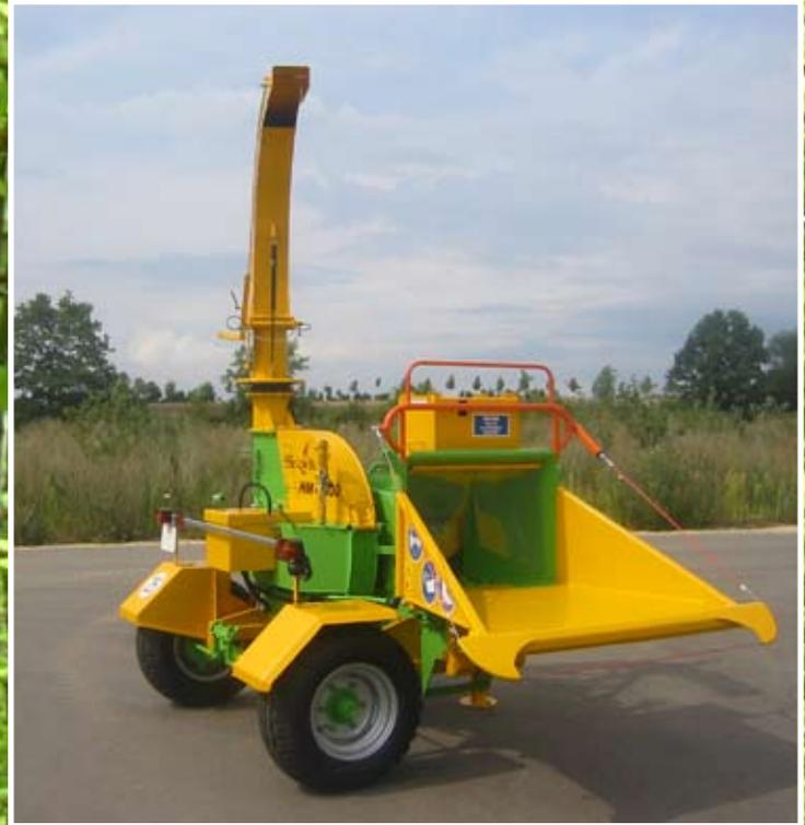
Alle handbeschickten Holzhackmaschinen mit Fahrgestell sind Produkte, die den Anforderungen des Geräte- und Produktsicherheitsgesetzes (GSPSG) entsprechen und das GS-Zeichen für „Geprüfte Sicherheit“ tragen. All diese Maschinen sind nur zur Handbeschickung zugelassen und mit einem am Einzugstisch umlaufenden Sicherheitsseil ausgestattet.
