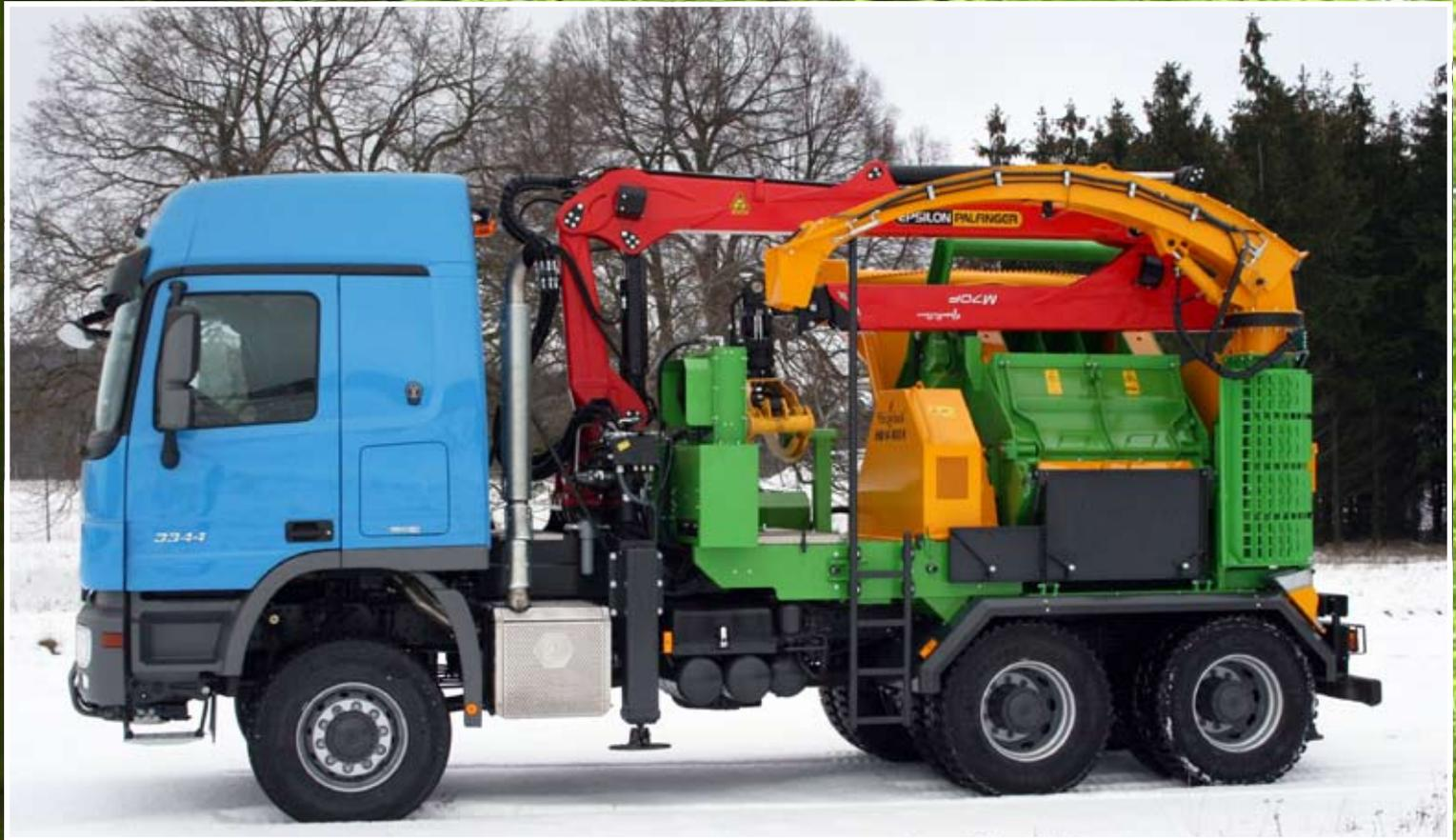
Aufgebaut auf einem bis zu 440 PS starken allradangetriebenen Mercedes Actros ist unsere leistungsstärkste Holzhackmaschine schnell vor Ort.
