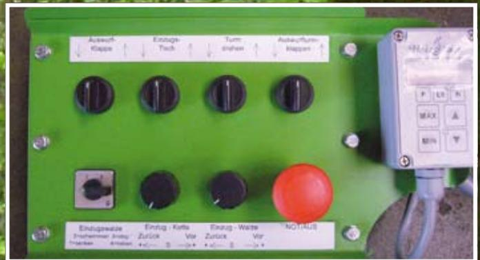
Die leistungsstarken Profimaschinen sind für Kran-beschickung serienmäßig mit ferngesteuerten Funktionen wie Turm drehen, heben, senken, Einzugstisch heben und senken, stufenlose Einzugsregelung über Servohydraulik, elektronische Drehzahl und Maschinensteuerung ausgestattet.
