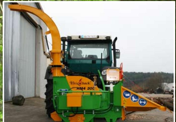
Mit den HEIZOHACK Holzhackmaschinen können Holzabfälle, wie Latten, Kantstücke, Stückhölzer, Schwarten, Baumschnitte und ganze Stämme mit einem Durchmesser bis zu 30 cm (300er Serie) und bis zu 40 cm (400er Serie) bei geringem Kraftaufwand zerkleinert werden. Eine Anpressrolle und eine Stahlbandkette mit angeschweißten Zähnen sorgen für einen kräftigen und zuverlässigen Einzug des Hackmaterials.
