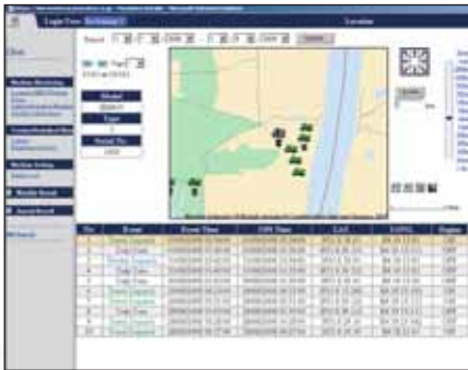
Seguimiento de las máquinas durante el transporte – Cuando se transporta su máquina, KOMTRAX™ envía mensajes al sitio web o por correo electrónico para informarle de su progreso, y confirma cuándo llega a su destino.
