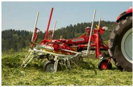
Adaptation au sol et préservation du fourrage caractérisent parfaitement les faneuses HIT. Une roue supplémentaire fixée sur la tête d'attelage jauge le sol juste devant les dents et réagit à chaque inégalité du terrain. Le résultat : un fourrage propre, moins de terre et un troupeau en meilleure santé!
