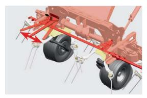
La mise en marche oblique de toutes les roues positionne la faneuse en travers et projette le fourrage de manière régulière vers la surface fauchée. Le fourrage n'est pas projeté au delà des limites de la parcelle. Le positionnement des roues vers la gauche ou vers la droite permet le fanage de bordure dans n'importe quel sens d'avancement.
