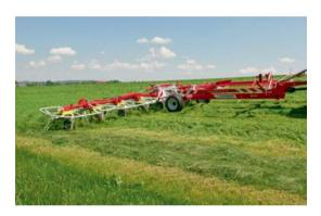
Les faneuses traînées HIT T avec 10 ou 12 toupies sont conçues pour les très grandes surfaces. Afin de répondre à la demande pour de grandes largeurs de travail avec un suivi parfait du terrain, les toupies sont montées individuellement sur articulations. En combinaison avec la fonction de guidage assurée par le chariot de transport, les HIT T garantissent un travail parfait, même à vitesse d'avancement élevée.
