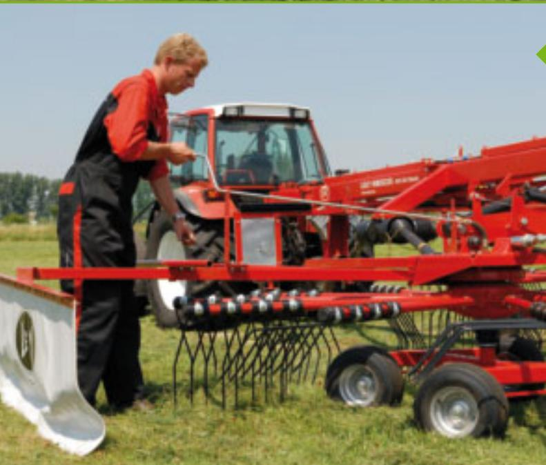
La altura de trabajo se ajusta por medio de una manivela. Esencial para un hilerado y un forraje limpio.
