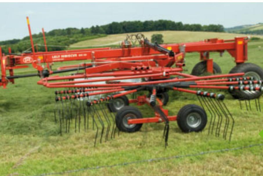
Gracias a la forma especial del diente Ro-tine, el forraje se levanta y se lleva a la hilera.
