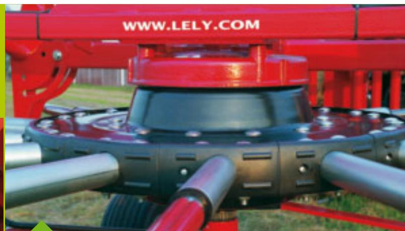
El rotor Master va cerrado, tiene una estructura modular y la excéntrica (ajustable) es lubricada con una grasa especial. Los ejes de los brazos de dientes de acero al cromo están provistos de cojinetes muy espaciados y los brazos de dientes son desmontables. Un brazo de dientes completo es fácil de desmontar.
