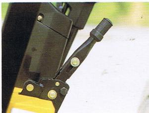
Handbremse mit Kipphebel
