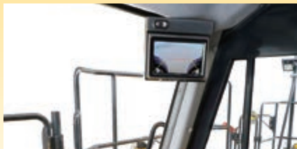
Das separate Display der Rückfahrkamera kann permanent oder nur beim Rückwärtsfahren angeschaltet sein.
