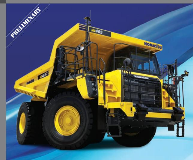
**ENGINE POWER** 578 kW / 778 HP @ 2.000 rpm **MAXIMUM GVW** 103.500 kg
