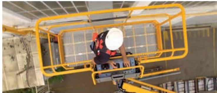
Bediener in großer Höhe sind einer Reihe von Gefahren ausgesetzt – insbesondere Quetschungsrisiken.
