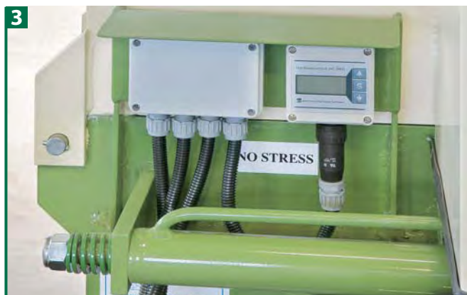
Die elektronische "No Stress"-Steuerung reguliert die Zuführung des zu hackenden Materials je nach der zur Verfügung stehenden Leistung und vermeidet damit eine Überlastung des Schleppers, bzw. Motors und der Maschine.
