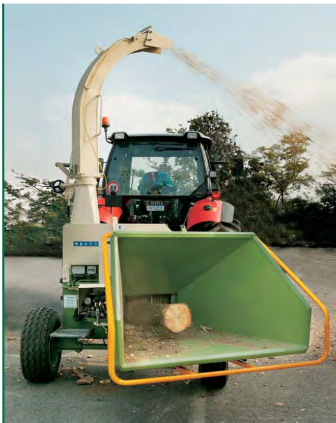
Modell H 880/250 hackt Stammdurchmesser bis 250 mm.
