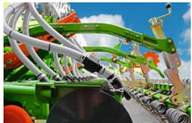
Érzékelő a vetőmag áramlásának meghatározásához a vetőcsoroszlyán
