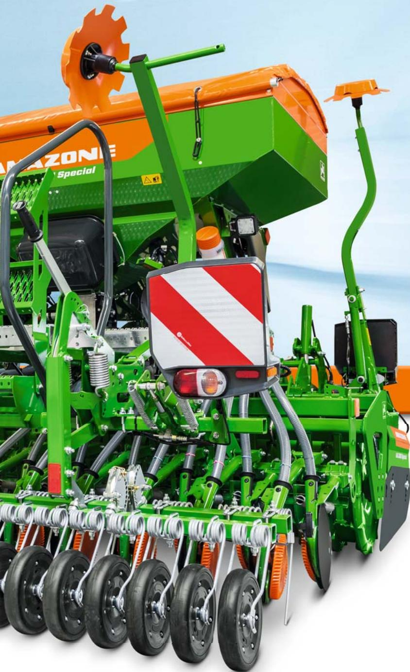
Le semoir compact pneumatique AD-P 3001 Spécial est un semoir très précis et fiable qui a été conçu pour la nouvelle herse rotative KE 01 et les nouveaux cultivateurs rotatifs KX et KG 01.
