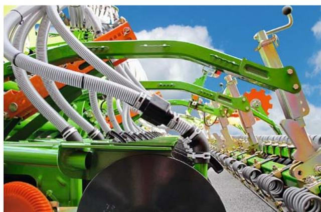
Capteur pour la saisie du flux de semence au niveau du soc semeur
