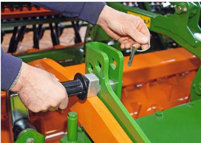
✔ Réglage de profondeur mécanique
