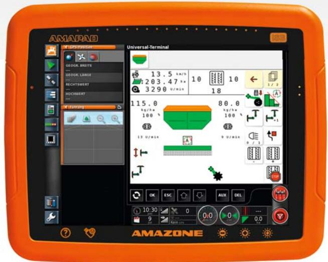
En plus de la coupure de tronçons GPS-Switch pro, un guidage manuel haute performance est également installé en standard avec GPS-Track pro. Les extensions de GPS-Track pro permettent d'obtenir un auto-guidage automatique.
