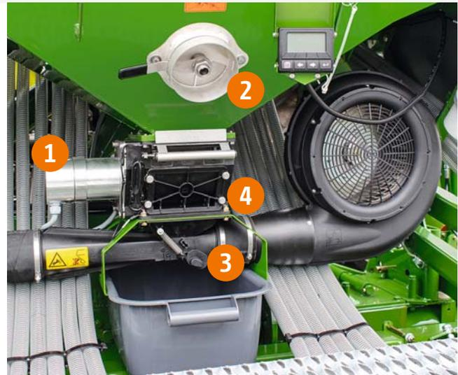
② **Vidange rapide :** la vidange de la trémie de semences est rapide et simple, grâce à la vidange rapide qui est positionnée bien accessible au niveau de la trémie.
