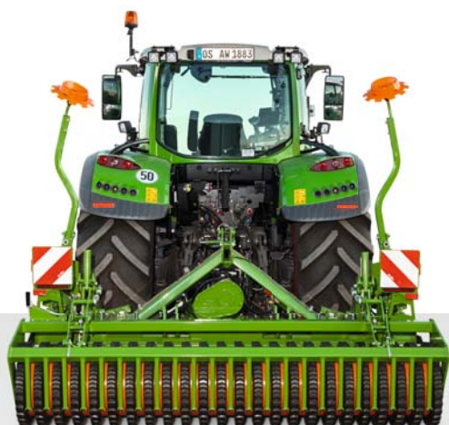
KG 3001 Super mit Spuranreißer und Keilringwalze mit Matrixreifenprofil KWM 600
