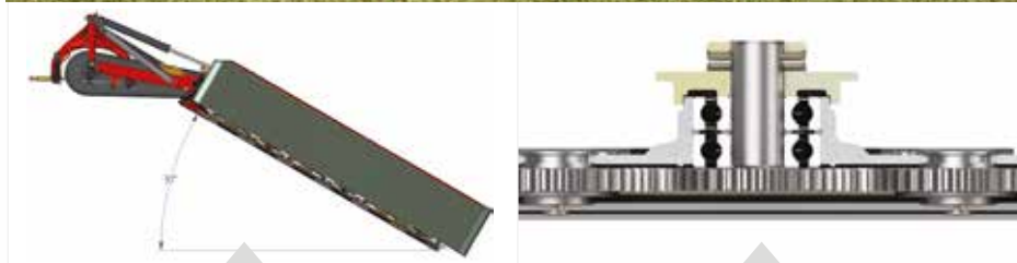
Boczne zawieszenie: umożliwia koszenie na pochyłym terenie
