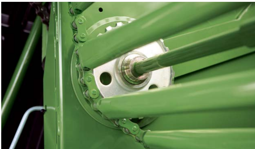
Rullo guida con elevatore a catenaria e barre (Fortima con camera variabile)
