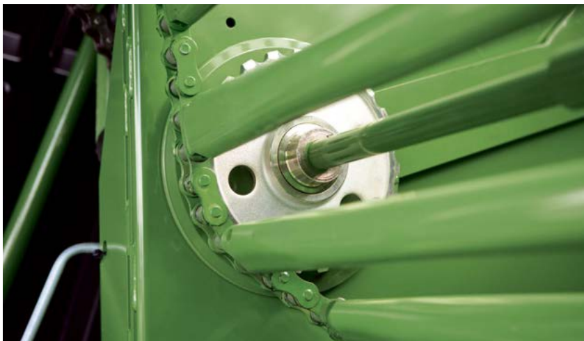
Vodící kladka s příčkovým řetězovým dopravníkem (Fortima s variabilní lisovací komorou)komorou)
