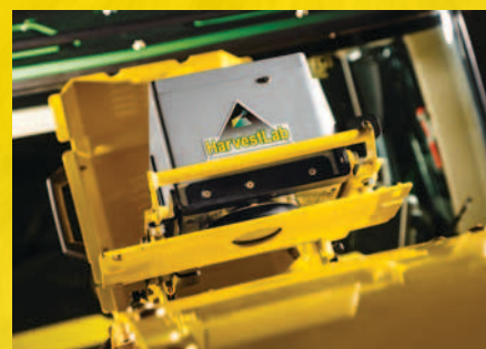
Sistema HarvestLab de medición de humedad y constituyentes
