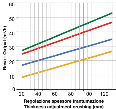
Produzione in condizioni ottimali su materiale di media e forte tenacità. Su tutti i modelli "FB" la regolazione della ganascia mobile, consente di ottenere frantumato di diverse dimensioni, a seconda dell'esigenza, da 18 a 130 mm.
