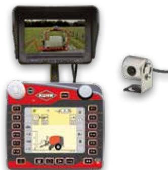
Для обеспечения оптимальной видимости и безопасности вокруг машины модели линейки FB могут оснащаться системой камер KUHN. Предлагаются 2 комплекта: один совместим с терминалом CCI, а второй состоит из отдельного монитора и камеры.
