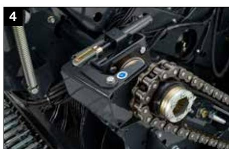
Гидравлическое отключение ротора
