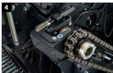
24 Гидравлическое отключение ротора
