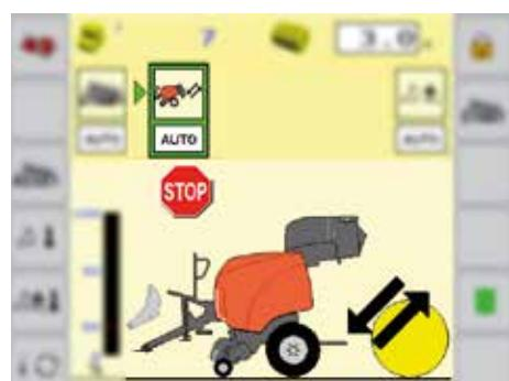
Обзор процесса автоматического открытия/закрытия заднего люка
