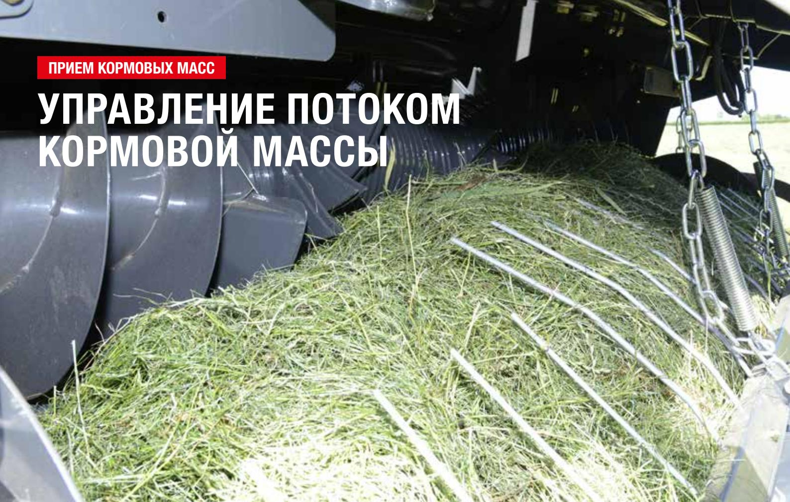
Пресс-подборщики KUHN FB обеспечивают оптимальный прием кормовых масс. Широкий кулачковый блок подбора на моделях с роторным приемом максимально адаптируется к земле благодаря маятниковому механизму, который позволяет работать в самых сложных условиях.
