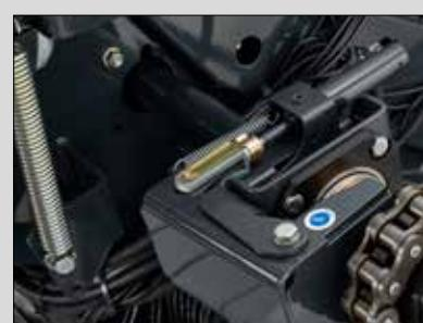
Гидравлическое отключение ротора
