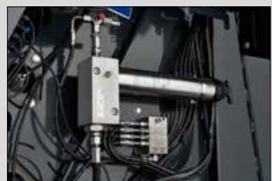
Система автоматической смазки для роликовых подшипников
