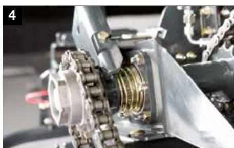
Механическое отключение ротора
