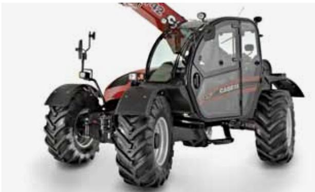
**Hundegang:** schräg versetzte Geradeausfahrt z. B. für Arbeiten an Mauern.
