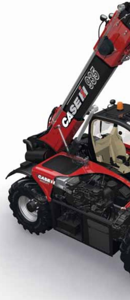
Die Kombination aus Ausgleichszylinder und Kippzylinder gewährleistet eine erhöhte Standsicherheit und ermöglicht die ruckfreie Führung des Teleskoparms.
