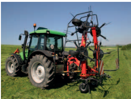
Fanex 604 is hydraulisch opklapbaar van werk naar transportstand en omgekeerd.
