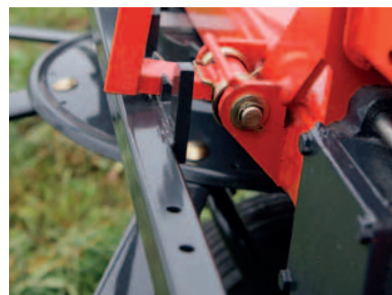
Standaard mechanische kantschudinrichting op de Fanex 464 en 524.
