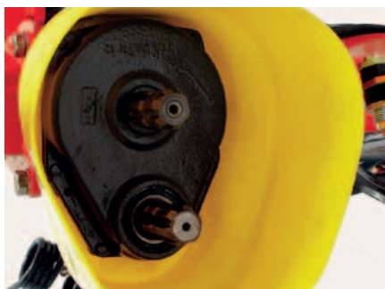
Optioneel met reductie-tandwielkast voor nachtzwaarden.
