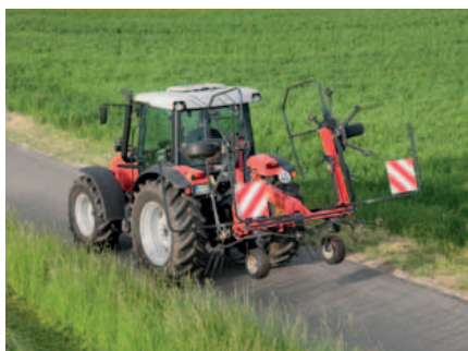
Alle schudders zijn hydraulisch opklapbaar van werk naar transportstand en omgekeerd.
