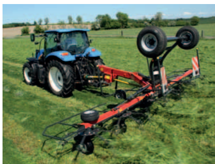
Fanex 763C met 6 rotoren en carrierframe.
