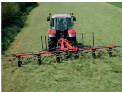
Haal het meeste uit het gewas. Met de kantschudinrichting blijft het gras binnen de perceelsgrenzen. Snel en eenvoudig mechanisch of hydraulisch verstelbaar, vanuit de trekkercabine.
