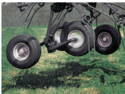
Optionele tandmassen verbeteren de bodemaanpassing voor de Fanex 464 en 524.
