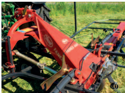
Het sterke design van de V-vormige aanbouwbok zorgt voor prima stabiliteit tijdens het schudden en maakt hoge rijnsnelheid mogelijk.
