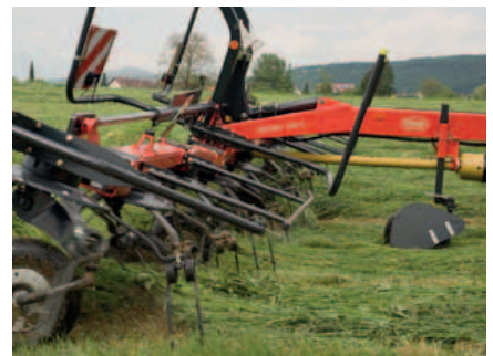
Het optionele derde wiel zorgt voor extra bodemvolging. Daarnaast kan het worden gebruikt voor een eenvoudige instelling van de hoogte.
