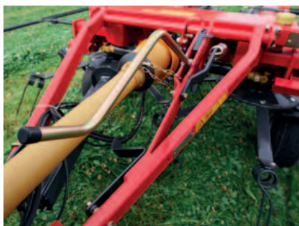
Eenvoudig instellen van rotorhoogte via een spindel aan voorzijde machine.
