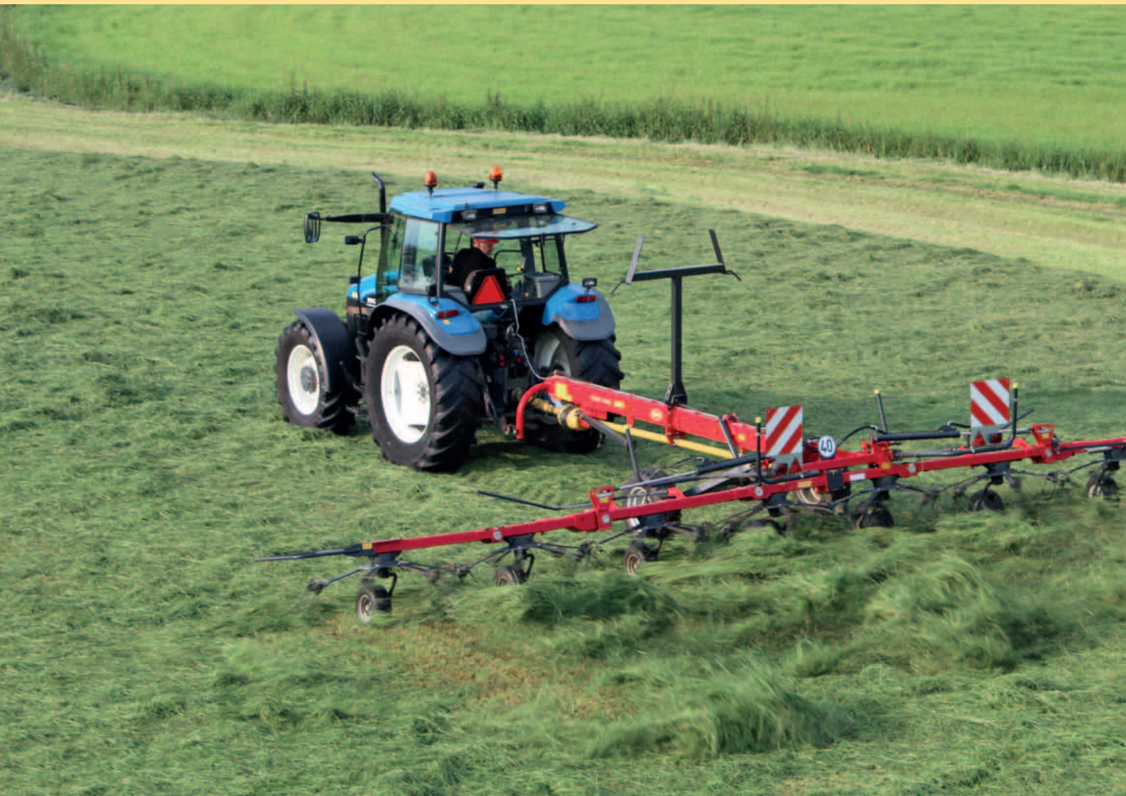
Fanex 1103C met 8 rotoren en 11,00 m werkbreedte.
