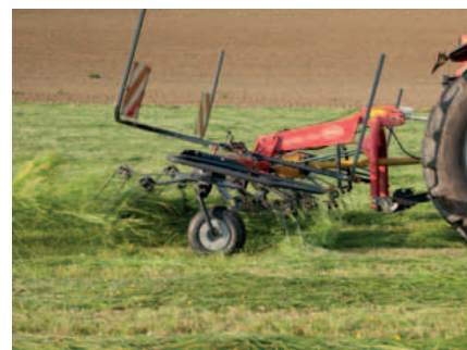
De standaard stabilisatoren zorgen voor een gelijkmatige spreiding.
