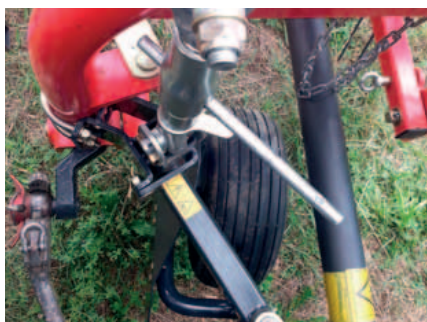
Optioneel kunnen de schudders worden uitgerust met een extra steunwiel voor betere bodemvolgving.
