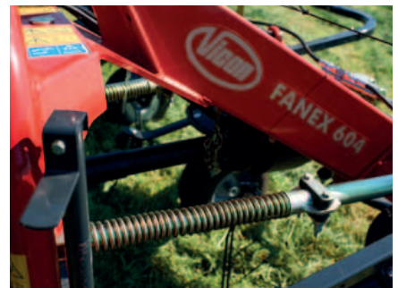
Standaard voorzien van stabilisatoren voor een gelijkmatig spreidbeeld.
