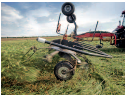
In werkpositie rust het carrierframe op het middenpunt van de machine.
