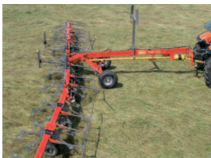
Voor het kantschudden kunnen de buitenste 3 rotoren hydraulisch naar binnen worden gezet.
