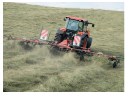
Con la scatola di riduzione dei giri opzionale è possibile la formazione di andane notturne.
