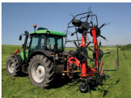
Il Fanex 604 si ripiega idraulicamente rimanendo molto compatto e vicino al baricentro del trattore.
