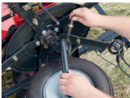
Facile regolazione dell'angolazione di spandimento.
