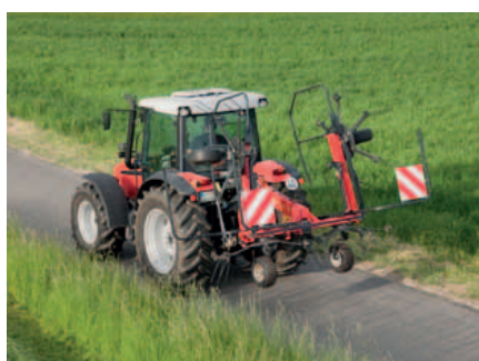
Tutti i voltafieno vengono richiusi e riaperti idraulicamente.
