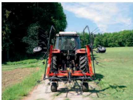
Durante la chiusura idraulica per il trasporto, i denti vengono sollevati automaticamente.
