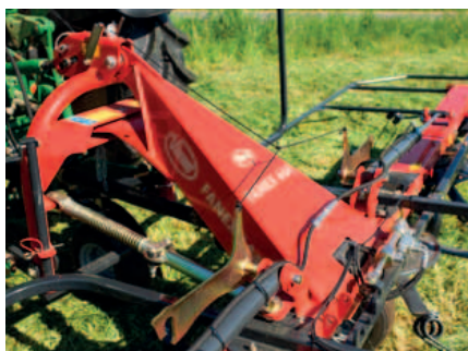
La struttura robusta del telaio centrale con profilo a 'V' offre un'elevata stabilità sia nel lavoro che nel trasporto.
