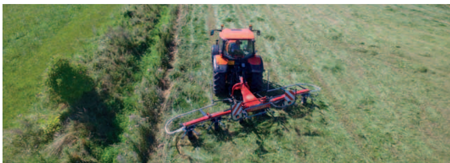
Per aumentare la produttività sono equipaggiati con un dispositivo di spandimento di bordura meccanico, ma è disponibile in opzione idraulico. Un indicatore mostra la posizione dell'assale.
