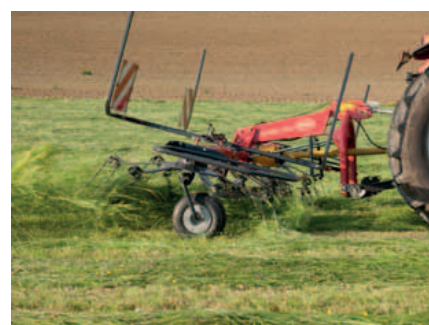
Gli ammortizzatori d'oscillazione standard offrono la massima stabilità.
