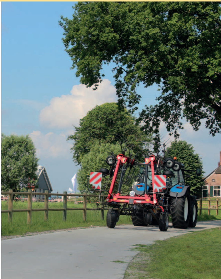
Durante il trasporto, entrambi i voltafieno presentano un'altezza inferiore ai 3,35m e una larghezza inferiore ai 3m.
