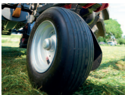
In opzione, questi voltafieno possono disporre di una terza ruota opzionale, per ottenere il miglior adattamento al terreno possibile.
