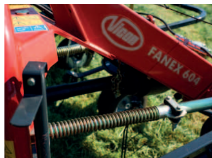
Gli ammortizzatori d'oscillazione standard assicurano un percorso di spandimento regolare.
