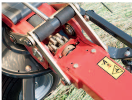
Le dita in acciaio con frizione HexaLink permettono ai rotori di richiudersi di 180° per il trasporto.
