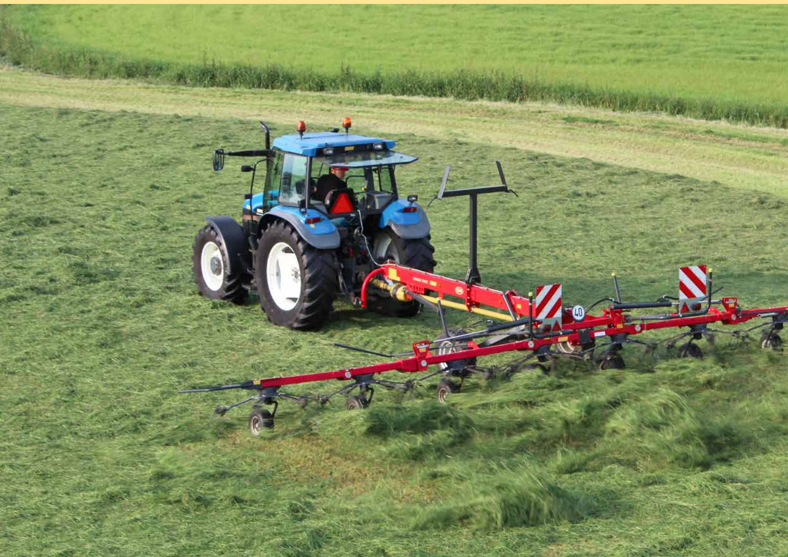
Fanex 1103C : 8 rotors et un petit gabarit au transport.
