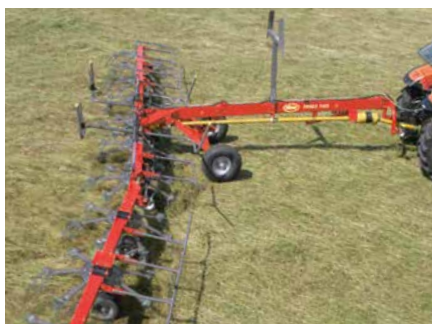
Pour le fanage des bordures les rotors extérieurs sont pivotants pour recentrer le fourrage.
