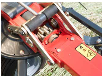
Entraînement à doigts Vicon HexaLink permettant un repliage au transport à 180°.
