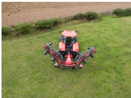
Le nouveau mécanisme de repliage garantit une répartition uniforme du poids pendant toute cette séquence.
