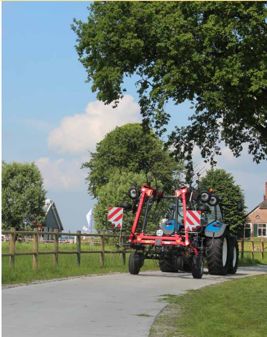
Pendant le transport, les deux faneuses ont une hauteur de moins de 3,40m et une largeur inférieure à 3,00m.
