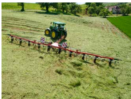
Angle de braquage de 80° qui garantit une parfaite manœuvrabilité.
