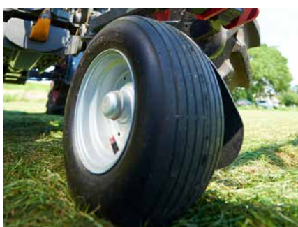
En option, les faneuses peuvent être équipées d'une roue de jauge améliorant encore le suivi des contours du terrain.
