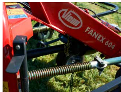
Les stabilisateurs garantissent une bonne stabilité pour un fanage parfait.
