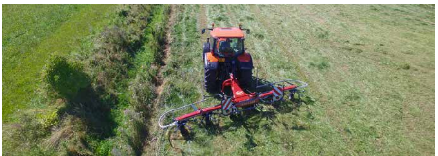
Maintenez votre fourrage à l'intérieur du champ grâce au dispositif de mise en oblique centralisé, qui permet de dégager les bordures. Un indicateur permet de visualiser la position de la faneuse.
