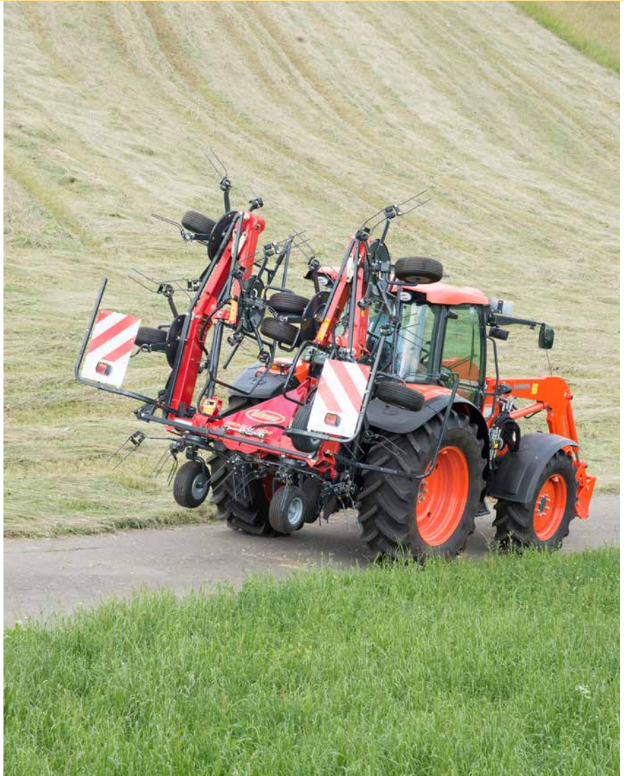
La Fanex 804 se replie au transport en position verticale.
