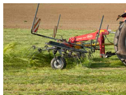
Les Fanex 464 et 524 sont équipées en standard d'amortisseurs d'oscillations.
