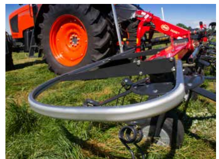
Nouvelle protection en aluminium, pour un poids allégé tout en garantissant une très bonne résistance aux chocs.
