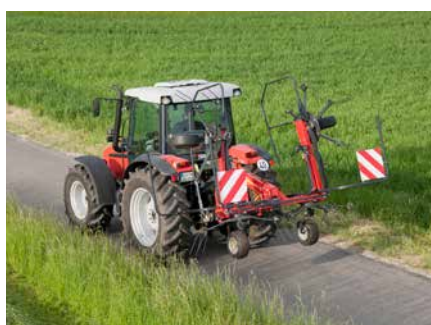
Toutes les faneuses offrent un repliage hydraulique de la position de travail et la position de transport, et inversement.
