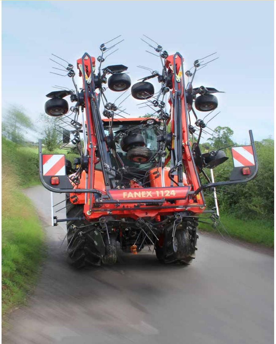
Dimensions compactes de transport de la Fanex 1124 - la taille de stockage est de seulement 3.80m.
