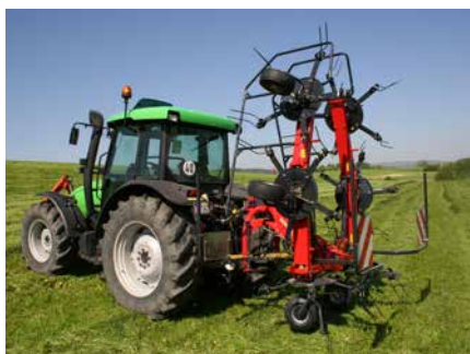
Toutes les faneuses offrent un repliage hydraulique entre la position de travail et la position de transport, et inversement.
