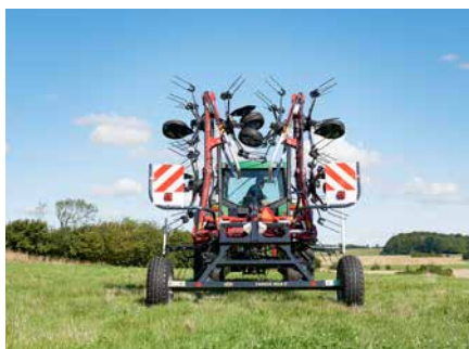
Le chariot de transport de la Fanex 904C est équipée de roues de 10.0 / 75 - 15.3 avec une voie de 2.45m.
