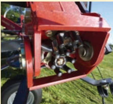
Embragues HexaLink que permiten el plegado de los rotores exteriores en 180°.
