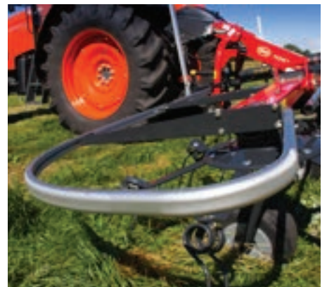
Guardas de protección de aluminio, ligeras y muy resistentes a los impactos.
