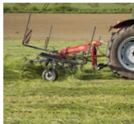
Los amortiguadores de oscilaciones mantienen la posición del volteador en trabajo.
