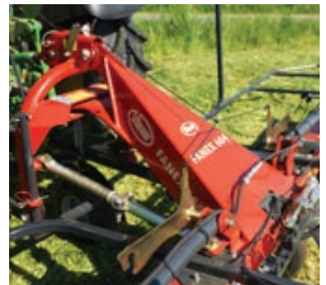
Unidad central robusta con diseño en "V". Alta estabilidad en trabajo y transporte seguro.
