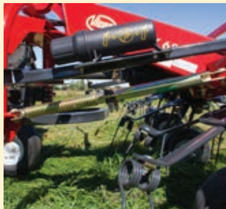
Amortiguadores de oscilaciones integrados en el cabezal pivotante.
