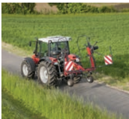
Todos los henificadores están equipados con plegado hidráulico para transporte.
