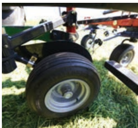
La rueda de soporte adicional en el cabezal (opcional) mejora el copiado del terreno.
