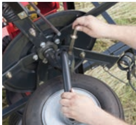
Ajuste del ángulo de lanzamiento de los rotores sin herramientas.
