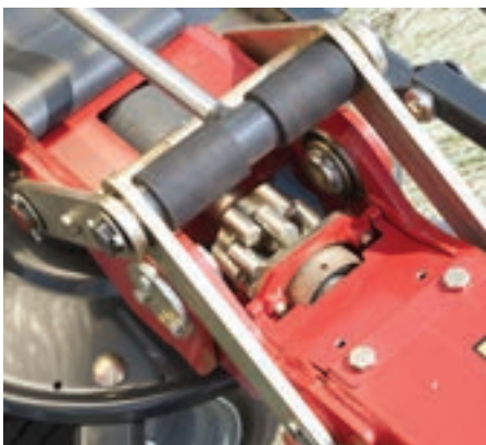
Embragues HexaLink que permiten el plegado de los rotores exteriores en 180° (Fanex 804).
