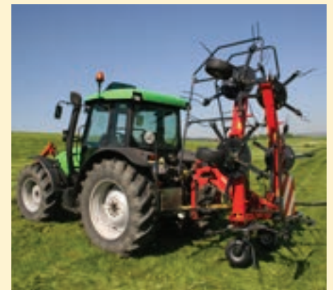
El paso a posición de transporte es hidráulico, quedando la máquina recogida tras el tractor.
