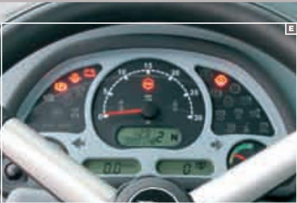
Lo strumento dell'elegante plancia è di tipo digitale e con semplicità e rapidità di lettura fornisce in tempo reale tutte le informazioni per la corretta guida del trattore e l'utilizzo degli attrezzi. Lo strumento dispone anche di un computer di bordo per il calcolo della superficie lavorata (Fig. E).
