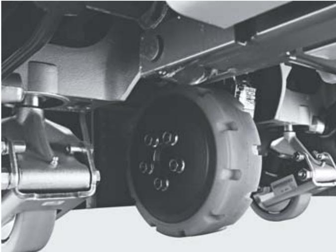
Robustes Fahrwerk und gefederte Stützräder für kraftvolle Rampenfahrten
