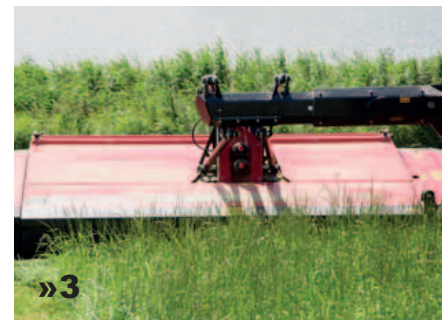
»3 L'unité de fauche s'abaisse alors uniformément sur le sol, sans que l'un des côtés ne touche le sol.
