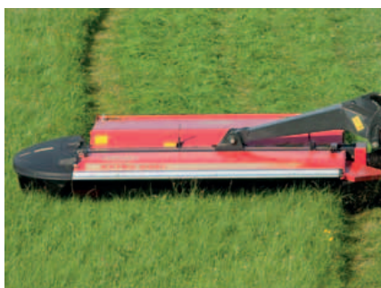
Suspension centrale pour une répartition de poids uniforme sur toute la largeur de travail.
