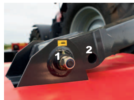
Deux positions de montage du lamier pour un chevauchement optimal.
