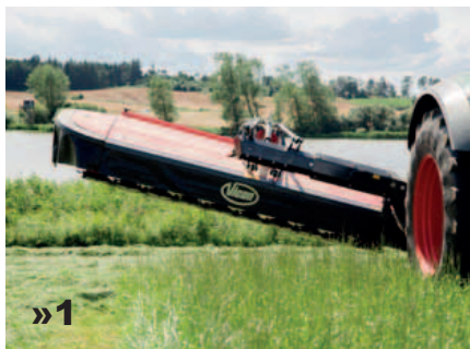
»1 Garde au sol de 500 mm sur l'ensemble de l'unité de fauche lors des manœuvres en fourrières. L'unité de fauche s'élève et le bras de support s'incline à un angle de 10°.
