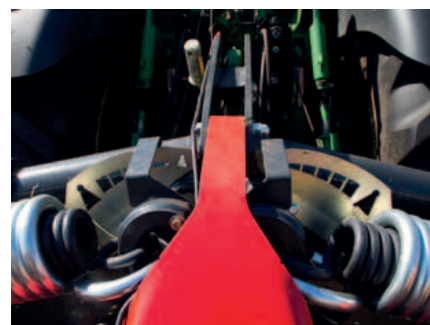
Ressorts de suspension de large section, réglables hydrauliquement, en option.
