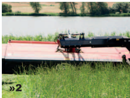
»2 Le bras de support revient en place pour amener l'unité de fauche en position stable avant d'être abaissée.
