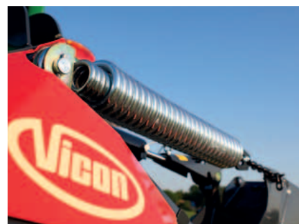
Le ressort de section importante garantit une flexibilité optimale sur toute la largeur de fauche.
