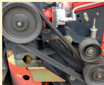
2 vitesses de rotation du conditionneur, pour une adaptation rapide aux différents fourrages et une diminution de la consommation de carburant.
