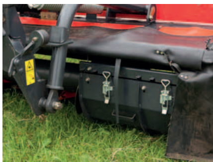
La largeur des andains est facilement réglable en déverrouillant et déplaçant latéralement les tôles d'andainage.
