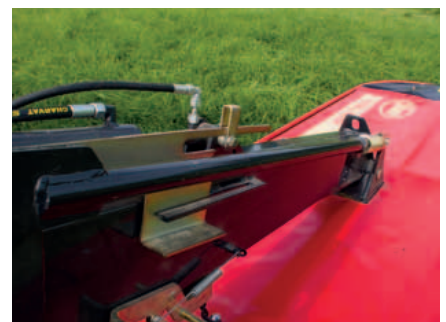
Toutes les irrégularités du sol sont absorbées par la suspension.
