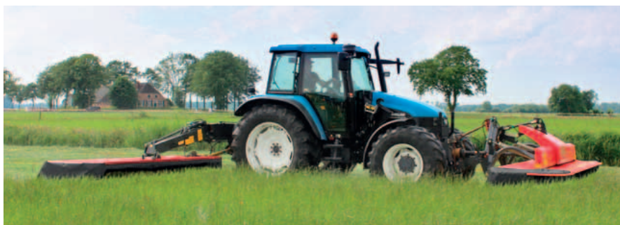
La suspension pendulaire permet une répartition des masses adéquate.
