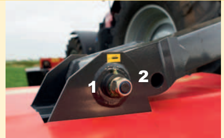
Unité de coupe avec 2 positions pour un recouvrement optimal.
