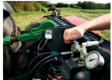
Réglage hydraulique de la pression au sol (EXTR \Delta 432H et 436H).
