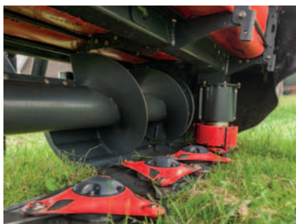
Dispositif d'andainage actif réalisant des andains structurés.
