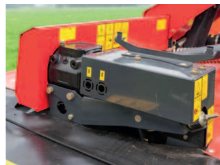
La vis est entraînée par un boîtier ne nécessitant que 5CV supplémentaire.
