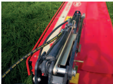
Relevage hydraulique en fourrière.
