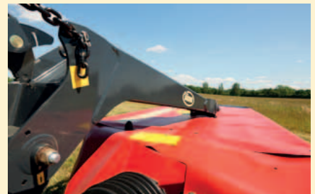
Articulation centrale des unités de coupe pour un suivi parfait des contours du terrain.
