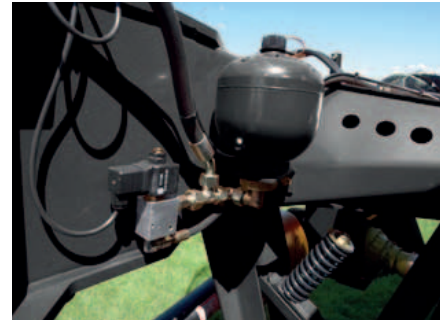
La suspension hydraulique assure un réglage précis de la pression au sol (EXTR \Delta 440H).
