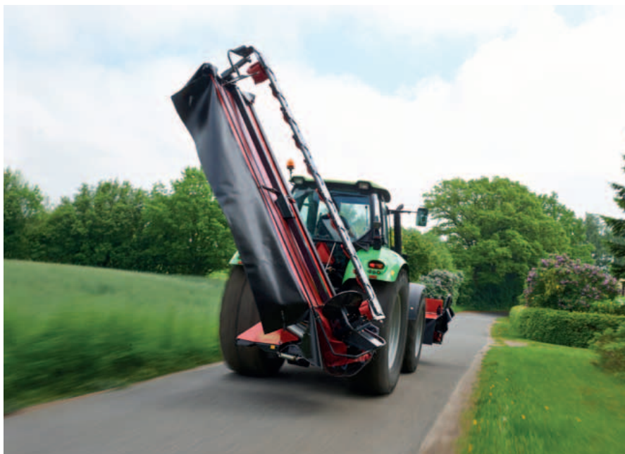
Position transport à 125° pour une excellente répartition du poids.
