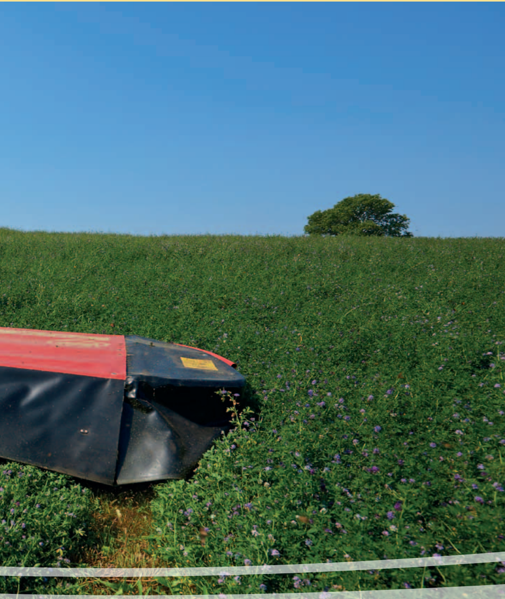
Unité de coupe avec 2 positions pour un recouvrement optimal.
